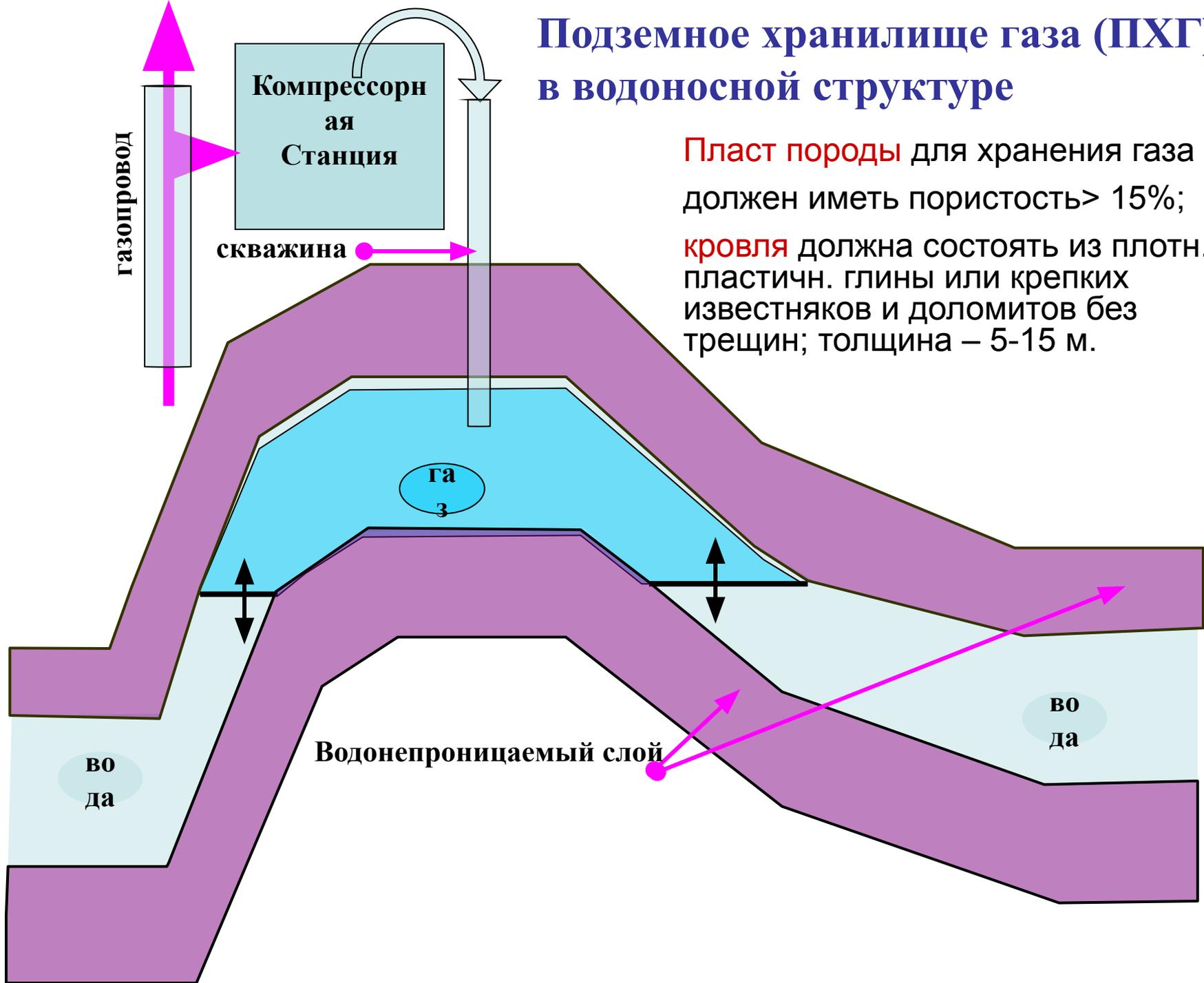
**Пласт породы** для хранения газа должен иметь пористость  $> 15\%$ ;
