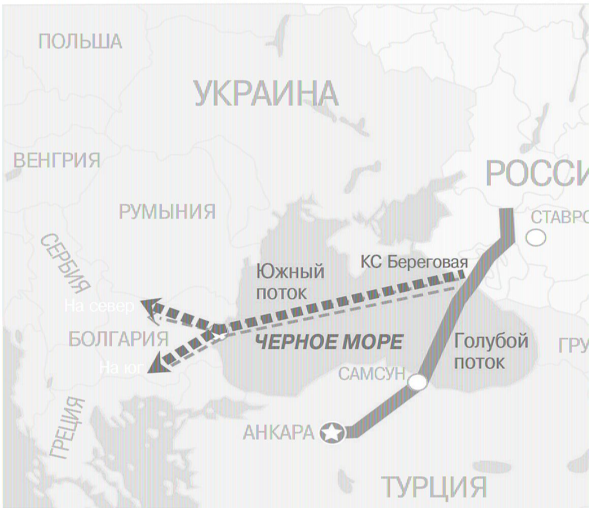
Россия, Германия, Франция и Италия заключили соглашение о совместной реализации проекта **«Южный поток»** – строительство газопровода мощностью 63 млрд. м<sup>3</sup> газа в год (к 2018г.) и стоимостью более 10 млрд. евро по дну Чёрного моря (протяженность морской части **Туапсе – Варна** равна 920 км). В 2010г. Россия начала сооружение сухопутной части. 07.12.2012г. сварен первый стык подводной части газопровода. Запуск в эксплуатацию – конец 2015г
