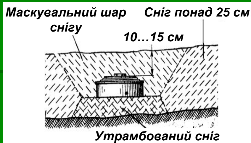
Встановлення ПТМ в сніг зі сніговим маскуванням
