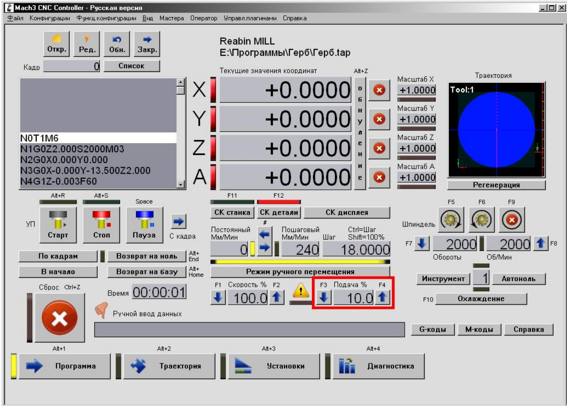
Основное рабочее окно программы **Mach3** в конфигурации для 4-х координатного фрезерного станка
