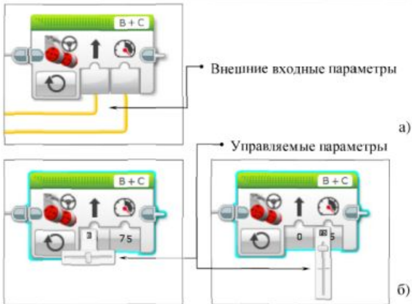
Рисунок 2.1.12. Параметры программного блока «Рулевое управление»
