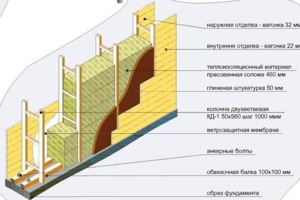
Конструкция наружной стены
