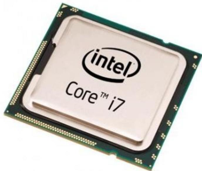
**Процессор** – это центральное устройство компьютера. Он выполняет команды находящейся в оперативной памяти программы и взаимодействует с внешними устройствами благодаря шинам адреса, данных и управления.
