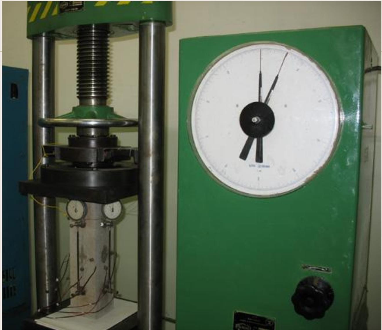
Таким образом, **призменная прочность  $R_b$**  – это временное сопротивление осевому сжатию призмы  $R_{bu}$  с отношением сторон  $\frac{h}{a} = 4$
