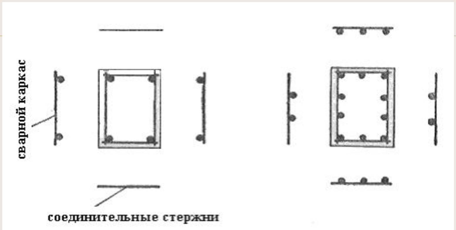
**Рис. 13.4. Схемы сварных каркасов арматурных колонн**
