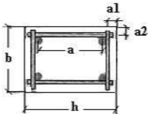
Рис. 13.3. Косвенное армирование сжатых элементов
