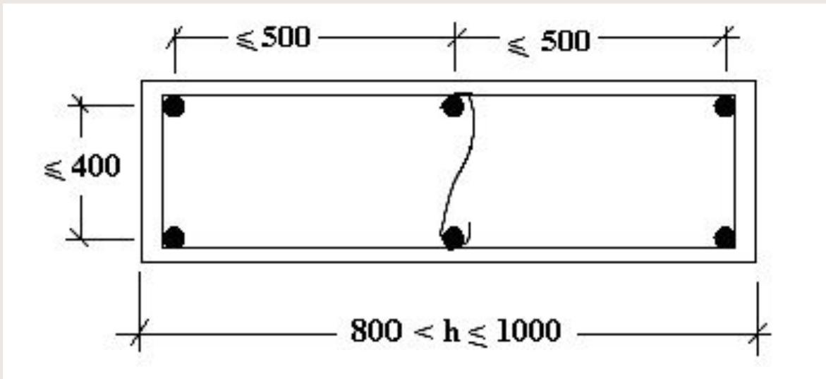
**Рис. 13.2. Армирование внецентренно сжатых сечений при размере поперечного сечения выше 800 мм ( $h \geq 800$  мм)**
