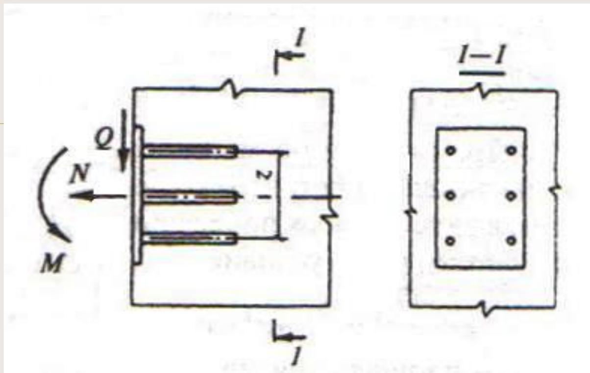
**Рис. 13.6. Схема усилий, действующих на закладную деталь**
