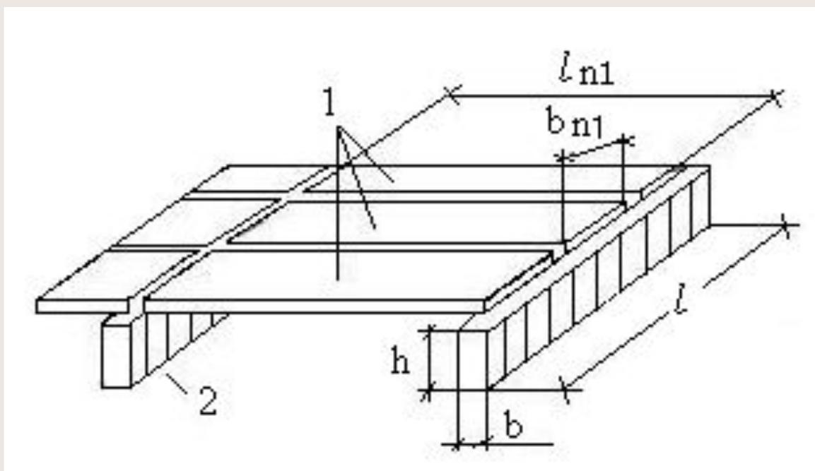
**Рис. 9.5. Схема сборного перекрытия**
