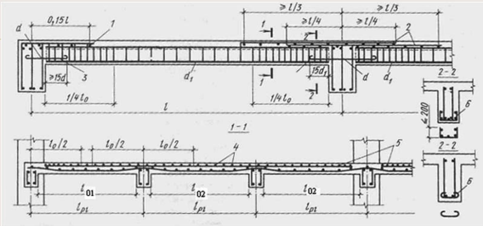
**Рис. 14.10. Армирование второстепенной балки
