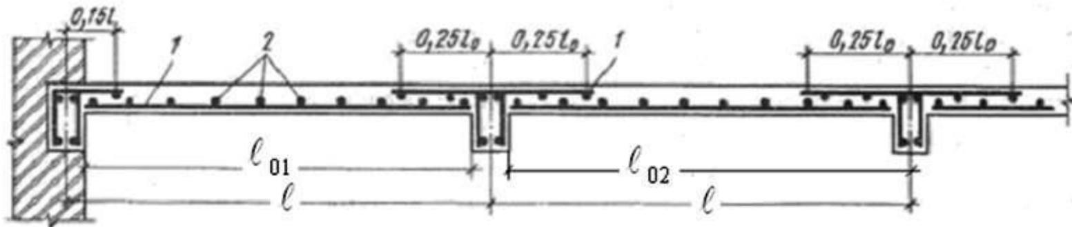
**Рис. 14.6. Армирование плиты плоскими сварными сетками**
