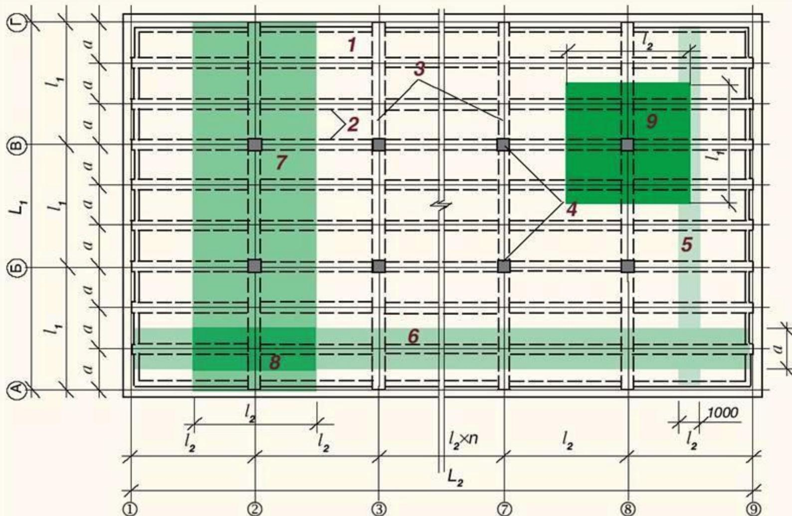
**Рис. 9.13. Расчетная схема монолитного ребристого перекрытия с балочными плитами**
