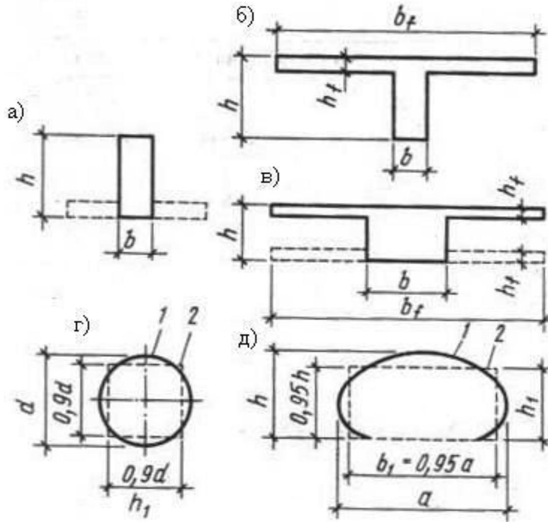
**Рис. 9.11. Расчетные поперечные сечения плит**
