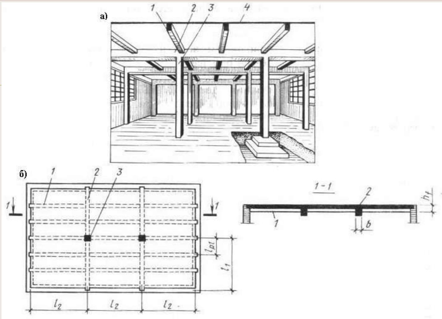
**Рис. 9.3. Монолитное ребристое перекрытие с балочными плитами**
