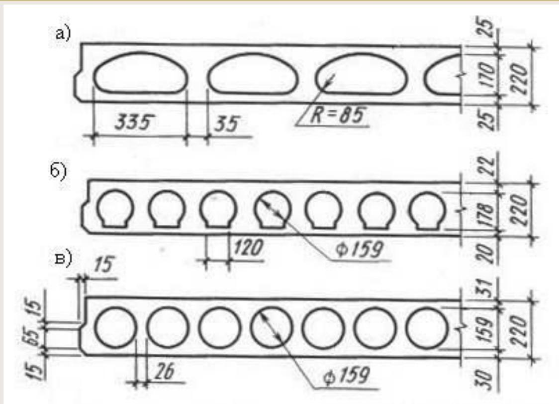
**Рис. 9.10. Плиты перекрытия**
