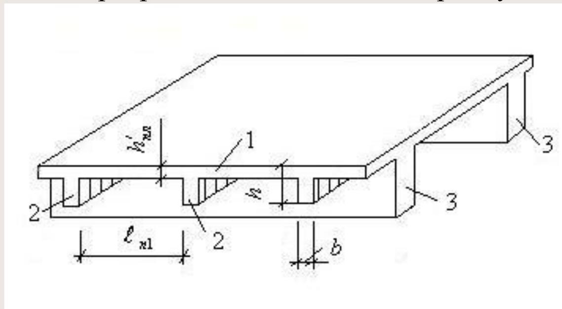
**Рис. 9.14. Схема монолитного перекрытия**
