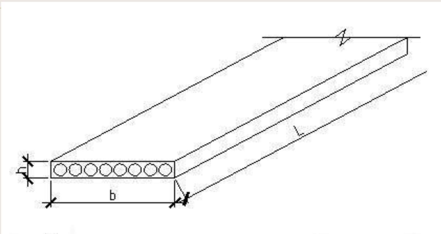
**Рис. 9.1. Схема пустотной плиты**
