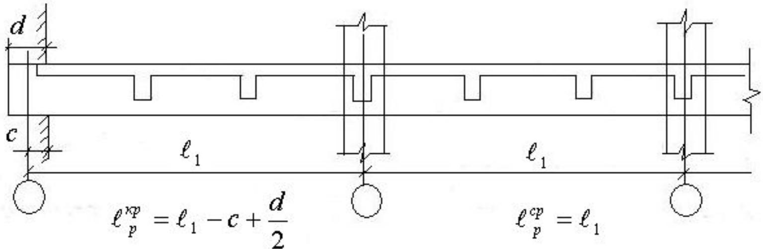
**Рис. 9.17. К расчету главной балки**
