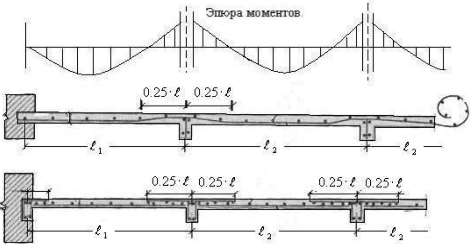
**Рис. 9.8. Армирование неразрезной плиты**
