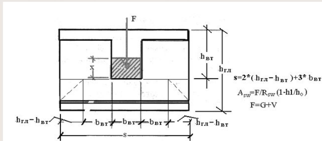
Рис. 15.6. Передача опорного давления второстепенной балки на главную
