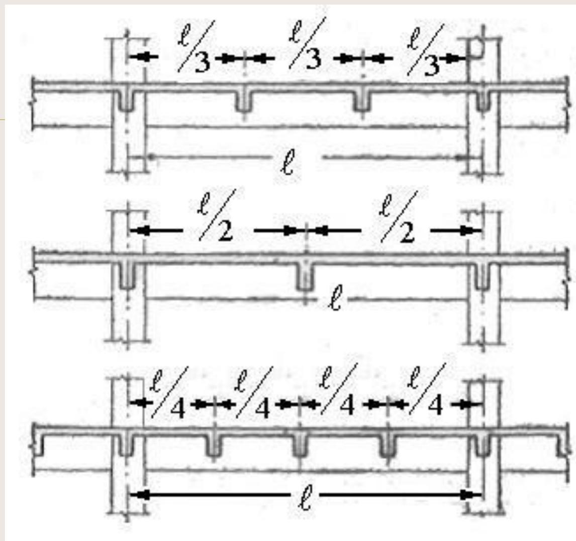
Рис. 14.2. Схемы второстепенных балок
