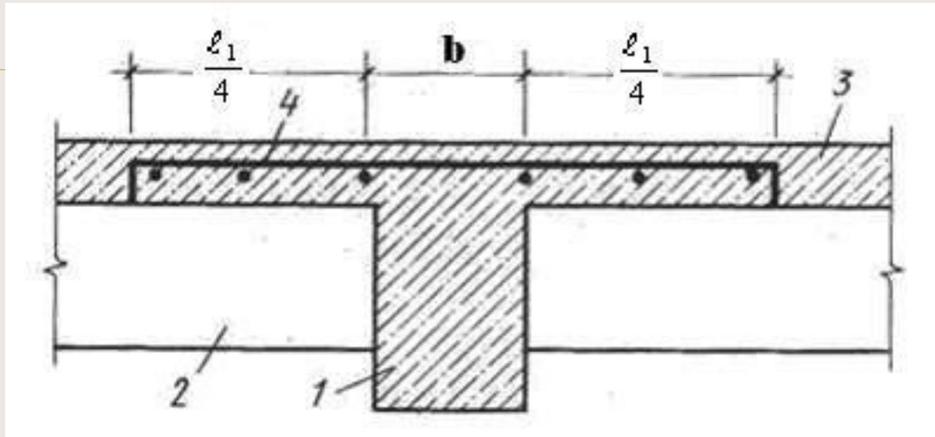
**Рис. 14.4. Армирование плиты отдельными стержнями**
