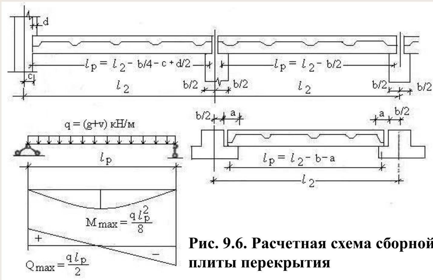
**Рис. 9.6. Расчетная схема сборной плиты перекрытия**
