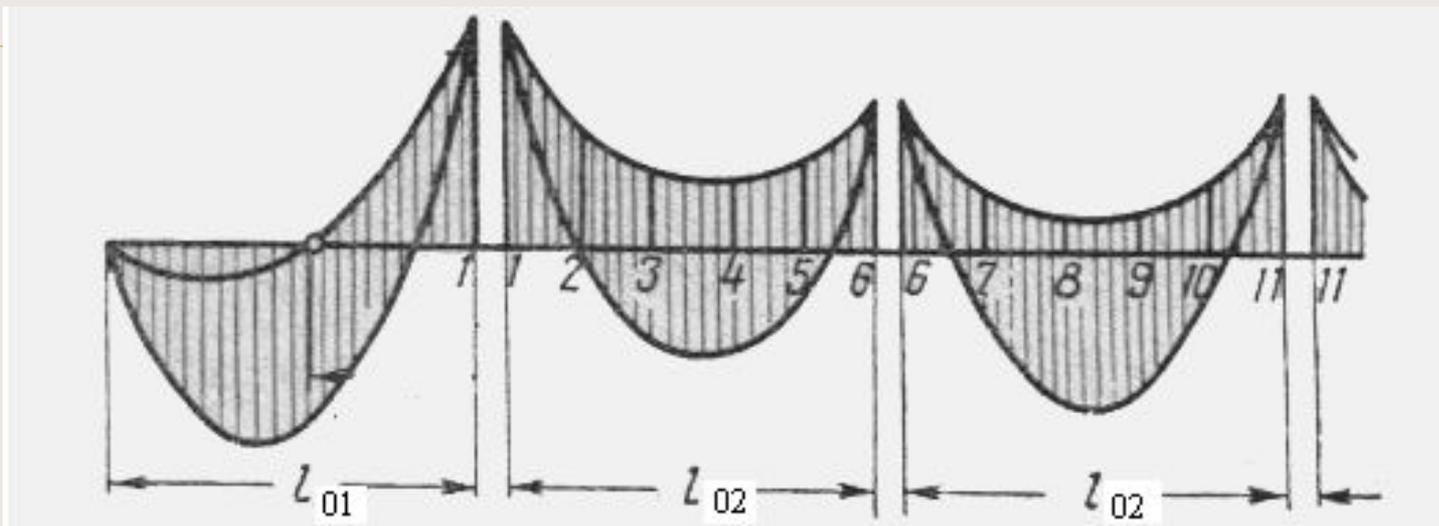
**Рис. 14.8. Огибающая эпюра второстепенной балки**
