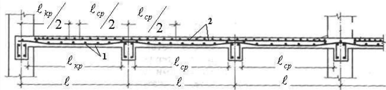
**Рис. 14.5. Армирование плиты рулонной сварной сеткой**
