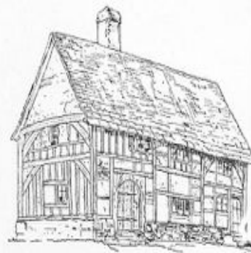
Примеры фахверковых конструкций
