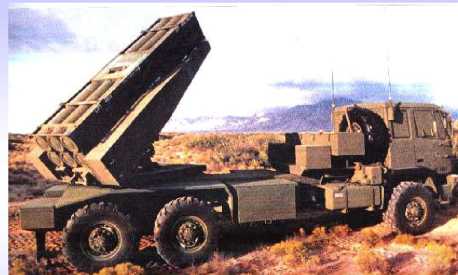
РЕАКТИВНАЯ СИСТЕМА ЗАЛПОВОГО ОГНЯ HIMARS (США, 2007 г.) максимальная дальность стрельбы - 45,5 км аэротранспортабельная самолетами типа С-130
