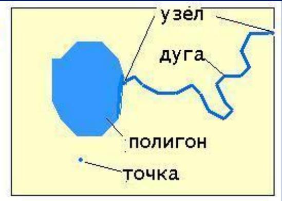
С помощью векторной модели объекты местности отображаются – линиями и полигонами, а с помощью растровой модели – по-разному окрашенными квадратиками.
