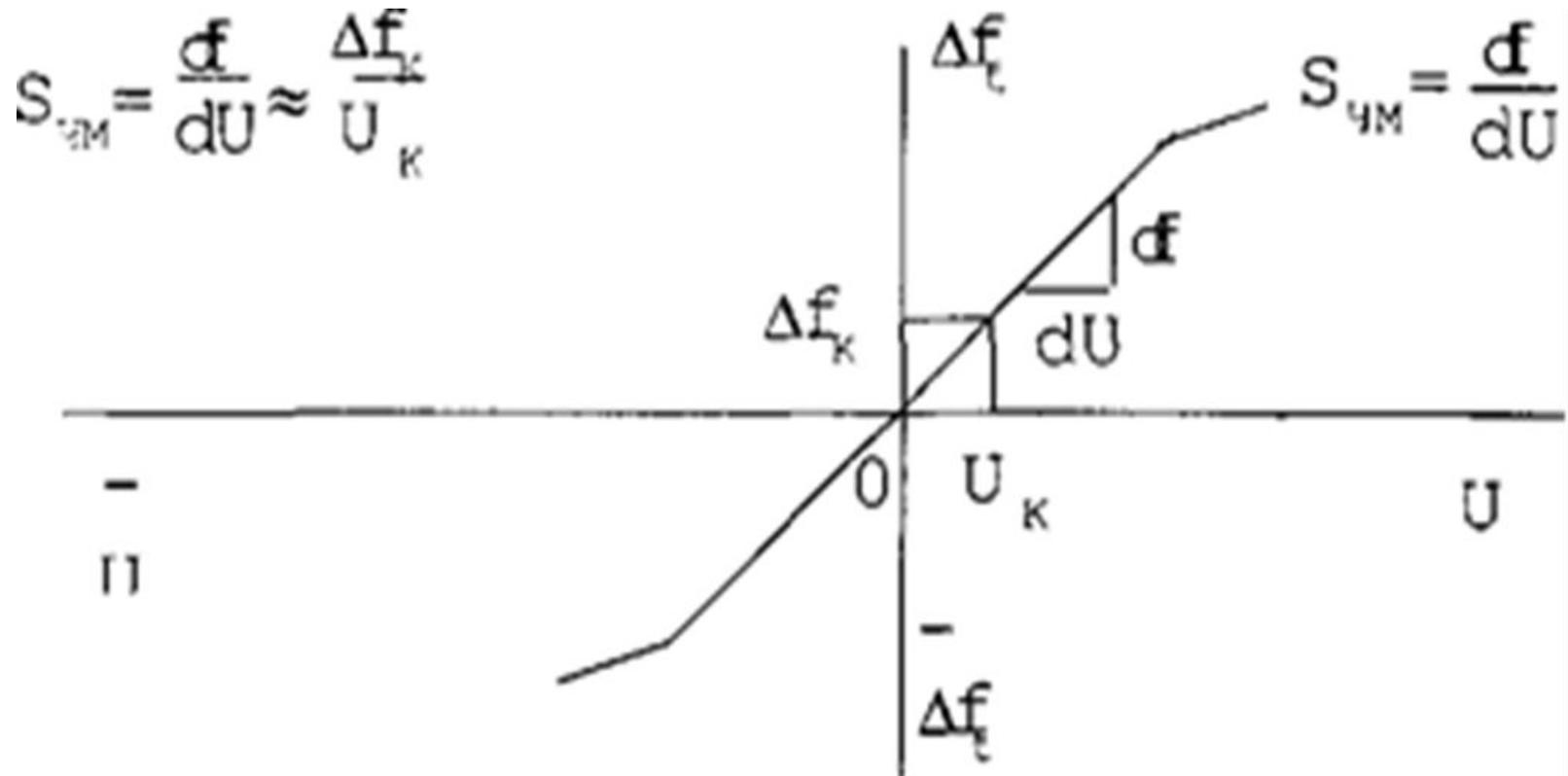
рис. 3.14. Модуляционная характеристика ЧМ модулятора радиопередающего устройства РРС с ЧРК-ЧМ.
