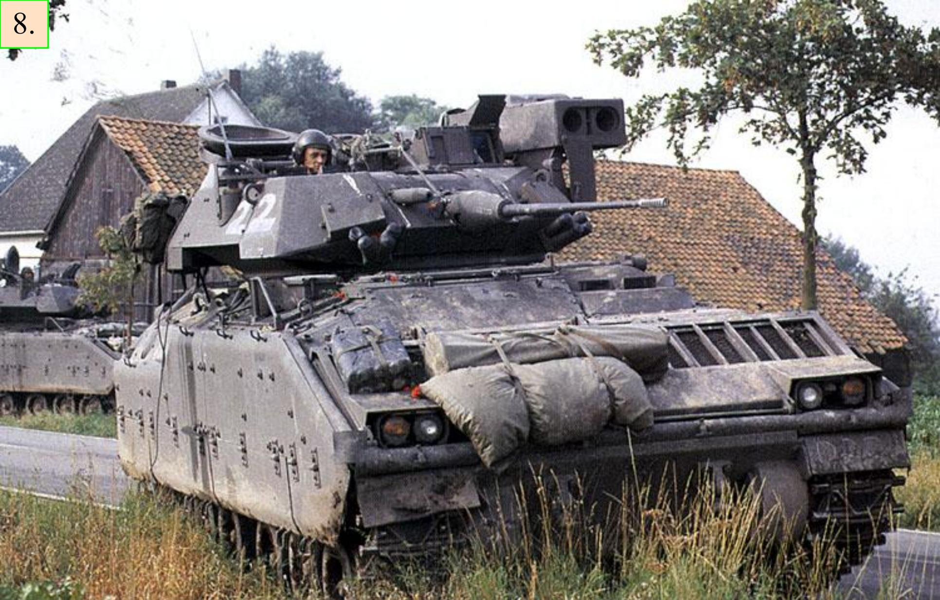
Фото 3. Боевая разведывательная машина (БРМ) М3 «Брэдли»
