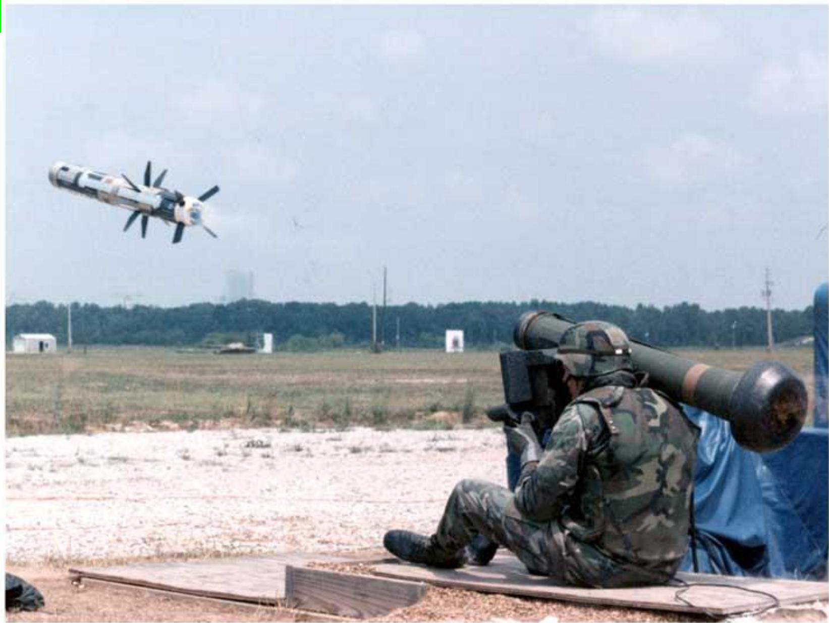
**Фото 10/2. Противотанковый ракетный комплекс (ПТРК) «Дракон»**
