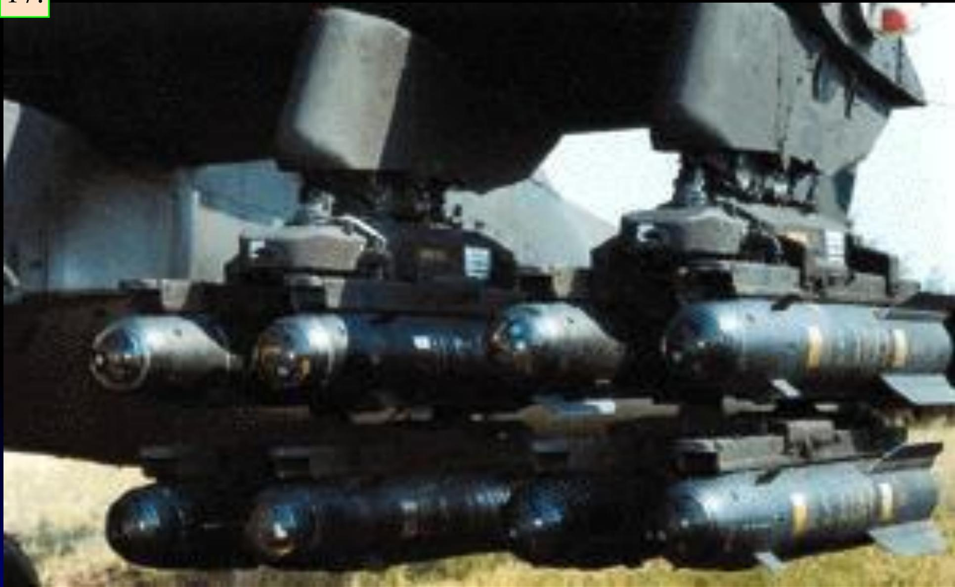
**Фото 12. Противотанковый ракетный комплекс (ПТРК) «Хеллфайр»**
