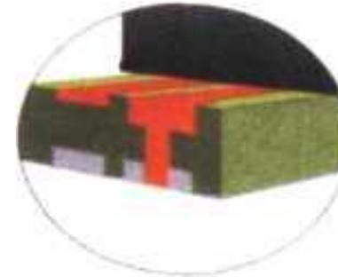
Заполнение углублений рельефа металлонаполненной пастой (контактолом) на другой стороне платы с использованием того же станка трафаретной печати с нормированной скоростью перемещения ракеля.
