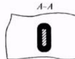
Рис. 4.14. Установка и пайка ЭРИ с плоскими планарными выводами, формованными для установки в сквозное O-образное монтажное отверстие РП
