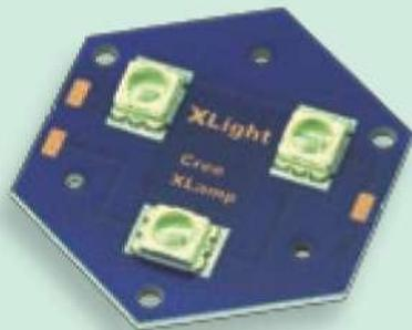
Известно, что КПД мощных светодиодов на порядок выше, чем у ламп накаливания, однако большая часть энергии, потребляемой светодиодами (около 75%), все-таки уходит в рассеиваемое тепло. С ростом светового потока от светодиодных источников растет тепловыделение.
