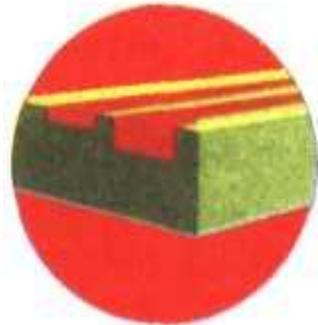
Термообработка в печи с нейтральной средой. Связующее металлонаполненной пасты выгорает. Металлические частицы спекаются, образуя металлическую дорожку - проводник и контактную площадку.
