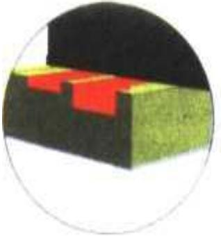
Заполнение углублений рельефа металлонаполненной пастой (контактолом).
