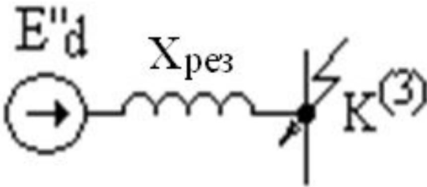
**Рисунок 3 – Схема замещения, преобразованная к простейшему виду**
