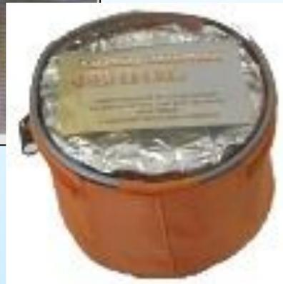
Защищает от аммиака, бензола, оксида углерода, нитрила акриловой кислоты, синильной кислоты, фосгена, хлора, сероводорода, двуокиси серы, вредных аэрозолей. Очистка воздуха осуществляется во встроенном эластичном фильтре одноразового использования. Капюшон обеспечивает защиту органов дыхания в течение 20 минут.
