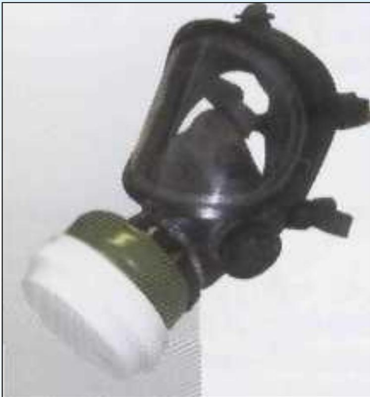
Предназначен для защиты органов дыхания, лица и глаз работников атомных электростанций, предприятий атомной промышленности от радиоактивных аэрозолей до 500 значений допустимой среднегодовой объемной активности, паров неорганических и органических соединений радиоактивного йода, органических паров, кислых газов и паров, отравляющих веществ при объемном содержании кислорода в воздухе не менее 17% и суммарном содержании вредных веществ не более 500 значений ПДК.
