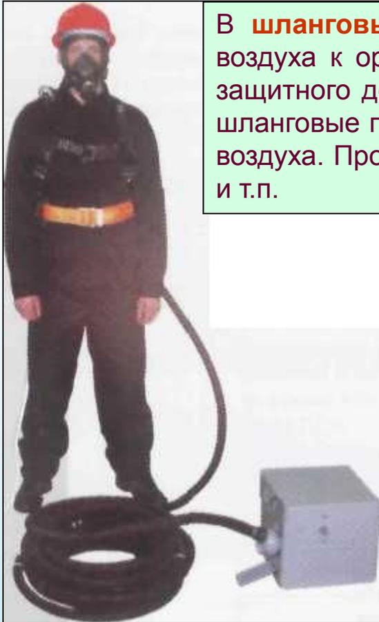
В **шланговых изолирующих противогазах** осуществлен принцип подачи воздуха к органам дыхания работающего по шлангу из чистой зоны. Время защитного действия противогазов не ограничено. По способу подачи воздуха шланговые противогазы делятся на безнапорные и с принудительной подачей воздуха. Противогазы используются при работе в емкостях, колодцах, отсеках и т.п.
