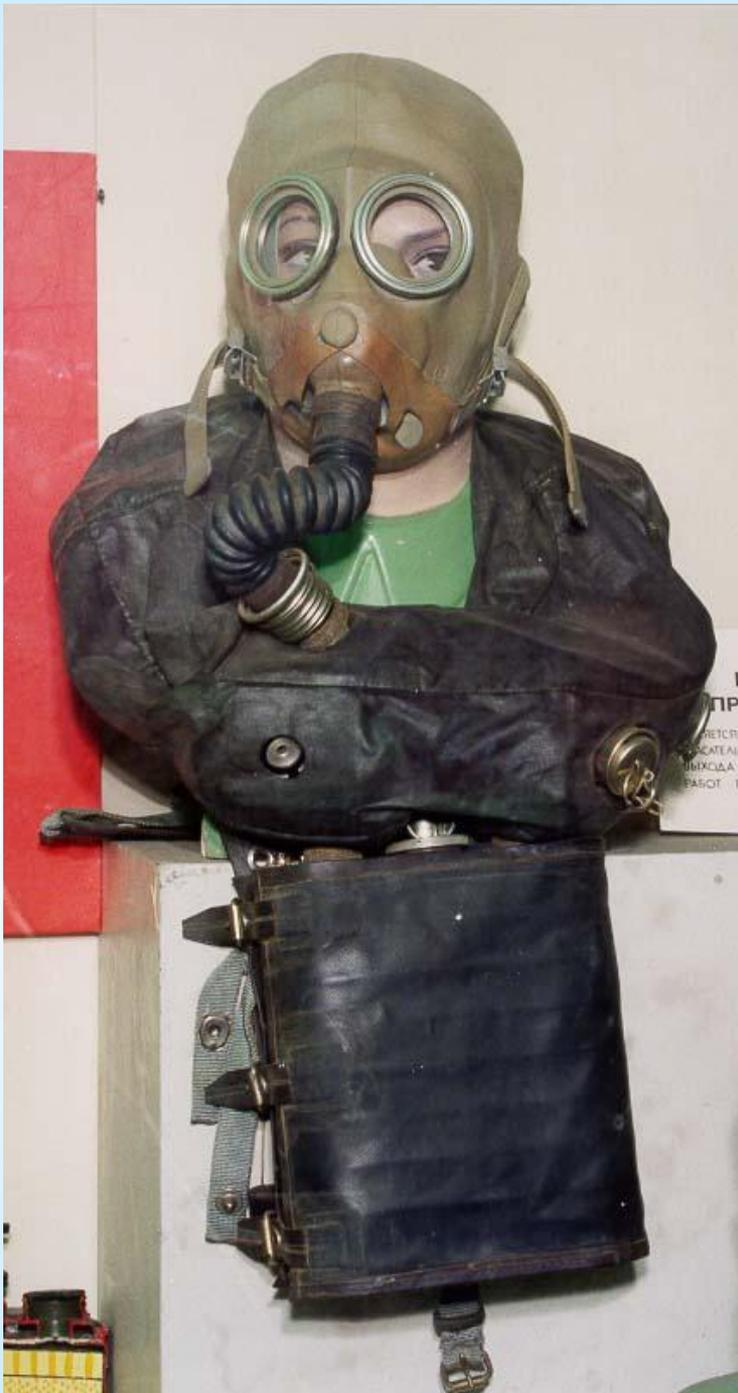
Предназначен для выхода из затепленных (затонувших) объектов бронетанкового вооружения методом свободного всплытия со скоростью 1 м/сек или методом постепенного подъёма на поверхность воды, а также позволяет выполнять под водой лёгкие работы и может использоваться на суше.
