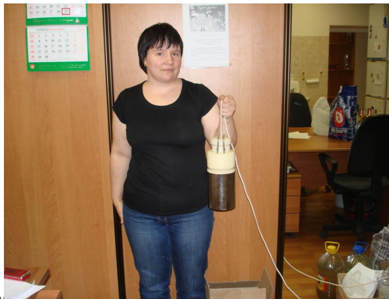
На рис. Прибор для забора воды Батометр
