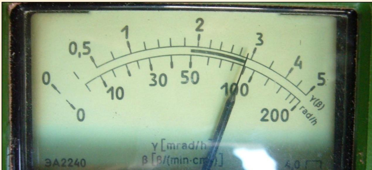
При отсутствии показаний после нажатия кнопки «Сброс» переключатель последовательно ставится в положение «x1000» ... «x0,1». Показания снимаются по **верхней шкале (мрад/час). При этом величина показания умножается на множитель поддиапазона.**
