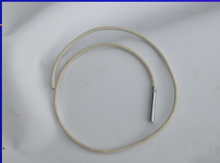
Зажигательные трубки промышленного изготовления (ЗТП-50) с терочным воспламенителем, (ЗТП-300) с механическим воспламенителем :
