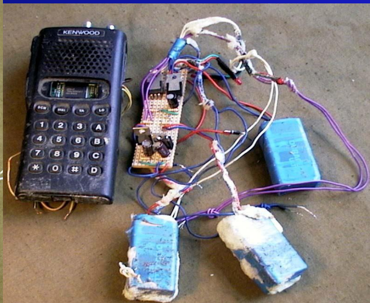
Радиостанция «KENWOOD» с исполнительным устройством на три электровзрывные цепи
