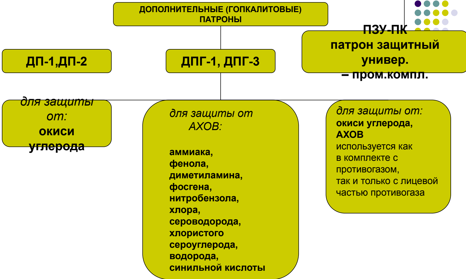
Назначение и защитные свойства дополнительных патронов
