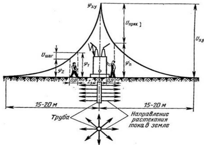
1 – потенциал шага; 2 – потенциал прикосновения; 3 – потенциал общего воздействия на человека электрического тока в земле с одиночного вертикального заземлителя
