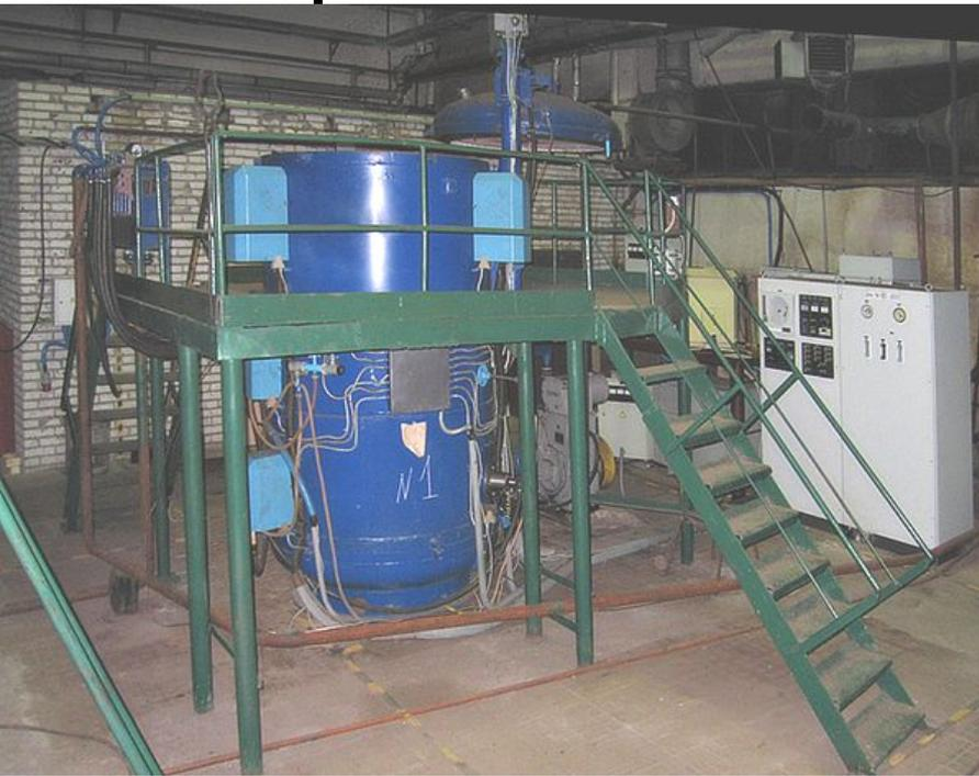
Установка ионной цементации ЭВТ 25
