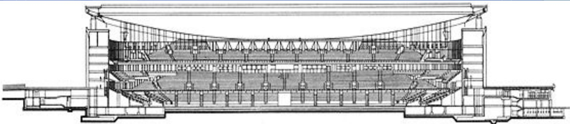
Здание эллиптическое в плане с размерами главных осей **224** x **183** м с ареной **120** x **86** м, площадью **32000** м<sup>2</sup>, перекрыто тонколистовой (толщиной **5** мм) оболочкой в форме эллиптического параболоида.
