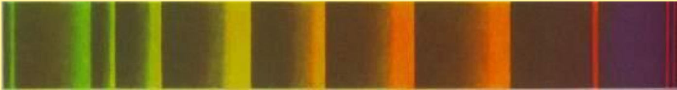
Спектр угольной дуги (полосы молекул CN и C 2 )
