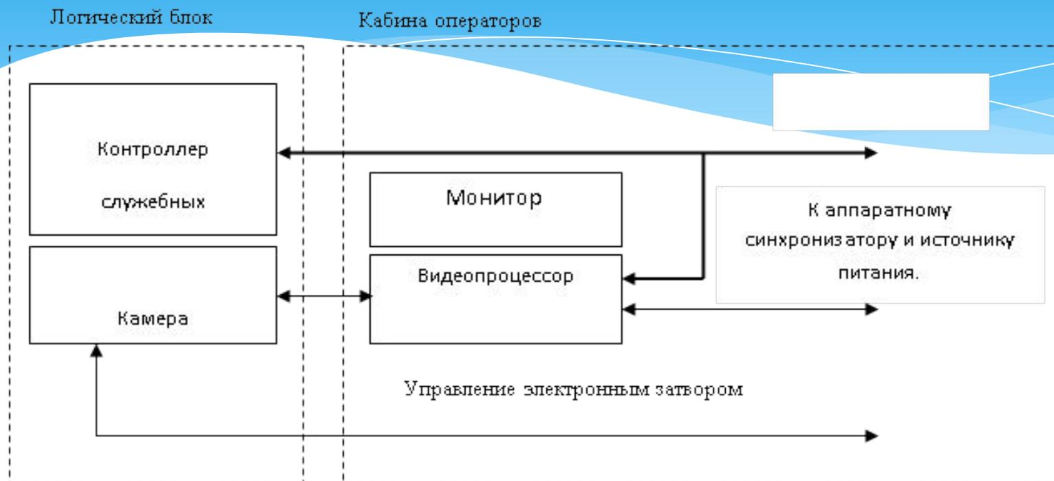
Рис. 12.2 Структура унифицированного телевизионного канала.
