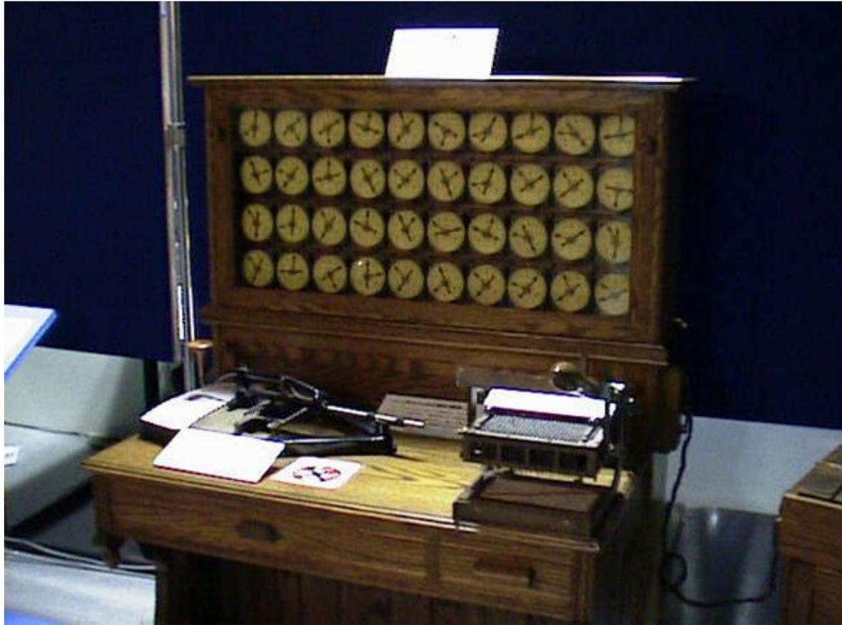
Табулятор Холлерита. Перфокарты считываются устройством, размещенном в углу стола. Сзади расположена панель с электромеханическими счетчиками
