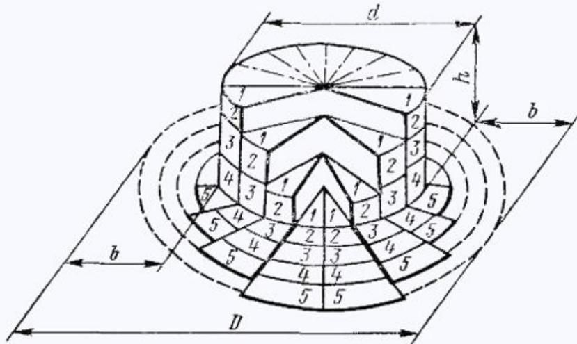
Вытяжка представляет собой процесс превращения плоской заготовки в полуо деталь любой формы (или дальнейшее изменение ее размеров) и производится на вытяжных штампах.
