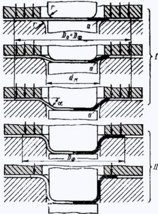
**Вытяжка** – образование полого изделия из плоской или полый заготовки. Вырубленную заготовку диаметром  $D_3$  и толщиной  $S$  укладывают на плоскость матрицы 3. Пуансон 1 надавливает на заготовку и она, смещаясь в отверстие матрицы, образует стенки вытянутой детали диаметром  $d$ .
