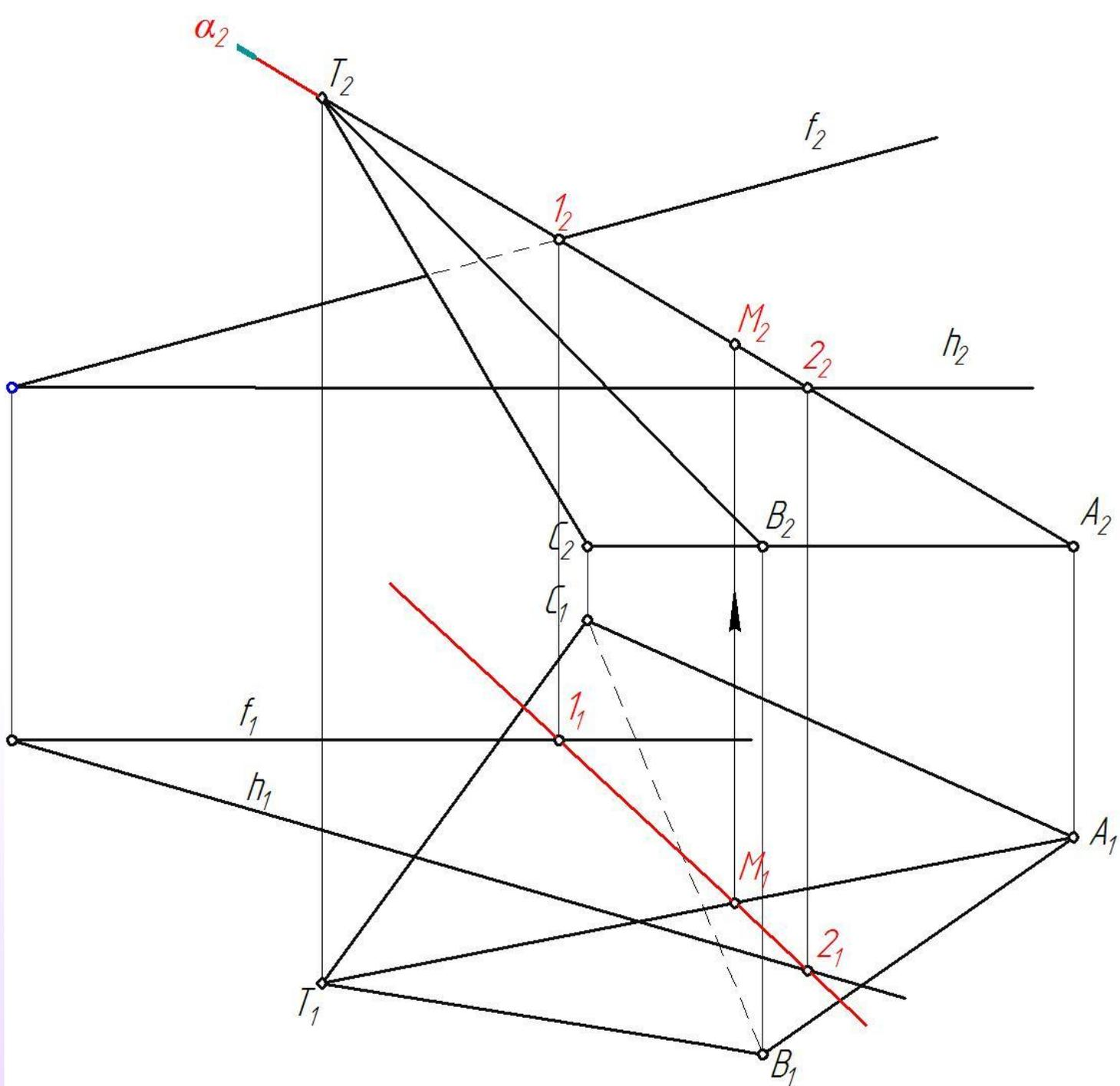
3. Точка пересечения построенной прямой (12) с ребром (ТА) есть первая точка линии пересечения
