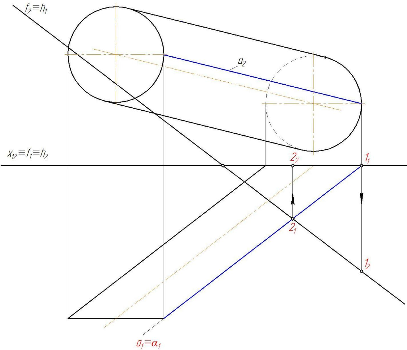
1. Образующую поверхности **a** заключаем во вспомогательную плоскость – посредник **α**.
