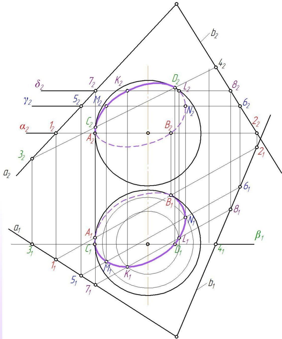
*Определяем видимость сечения.*
