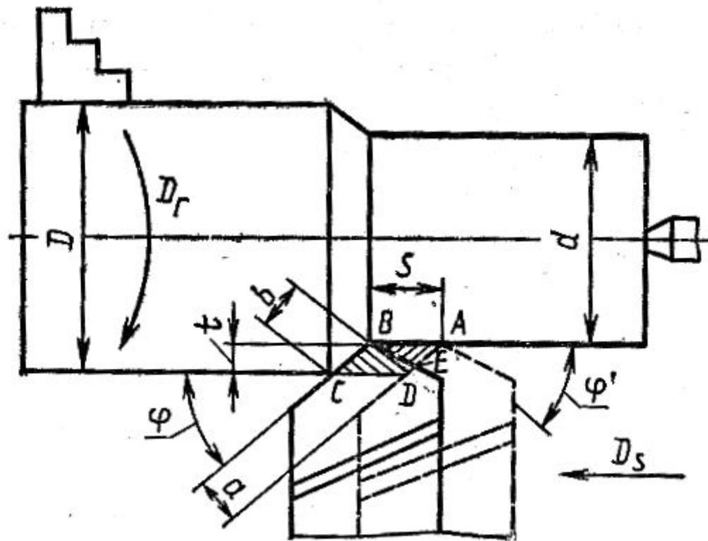
Рис. 1.2. Элементы режима резания при токарной обработке
