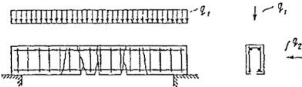
Появление в изгибаемых элементах **поперечной**, практически перпендикулярной продольной оси элемента, **трещины**, проходящей через все сечение, может быть связано с воздействием дополнительного изгибающего момента в горизонтальной плоскости, перпендикулярной плоскости действия основного изгибающего момента (**например, от горизонтальных сил, возникающих в подкрановых балках**).
