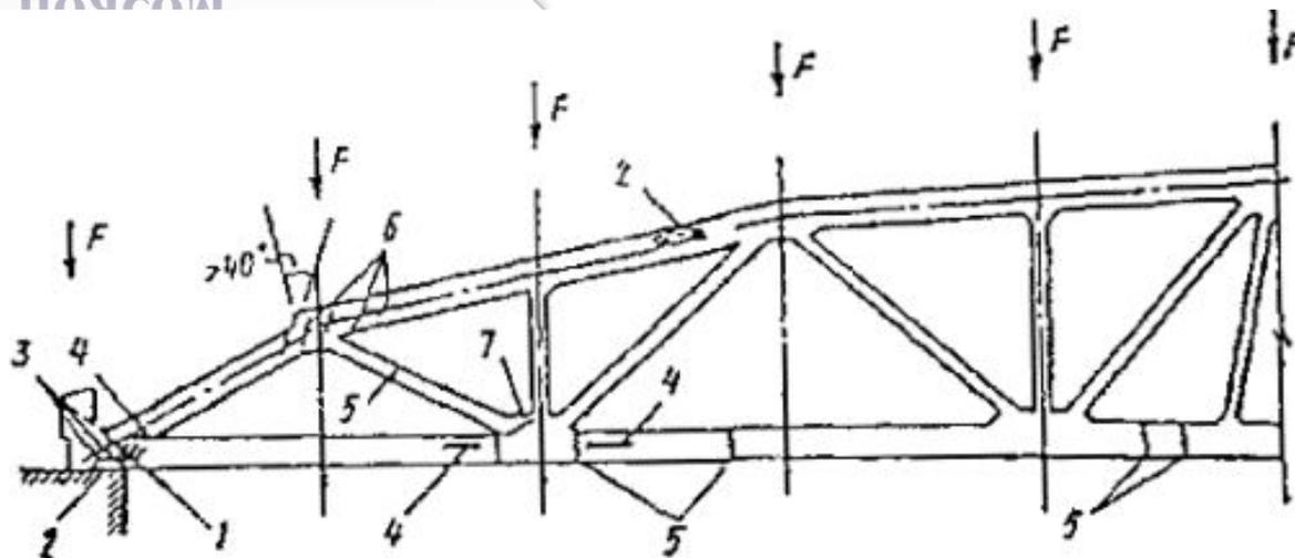
Элементы решетки раскосных железобетонных ферм могут испытывать **сжатие**, **растяжение**, а в опорных узлах - действие **перерезывающих сил**.
