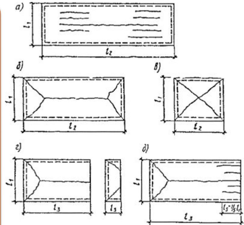
а - работающих по балочной схеме при  $l_2/l_1 \leq 3$ ;
