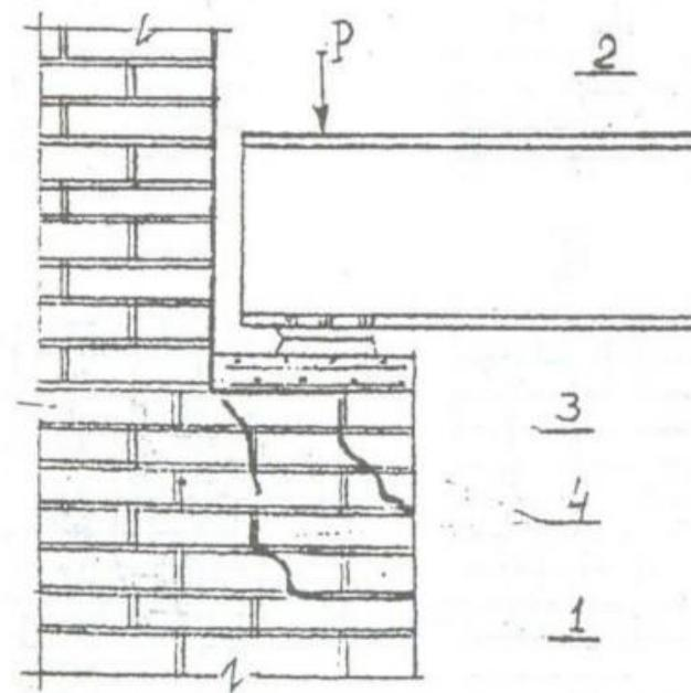
Рис. 3. Разрушение кладки пилыстры под опорной подушкой металлической балки:
