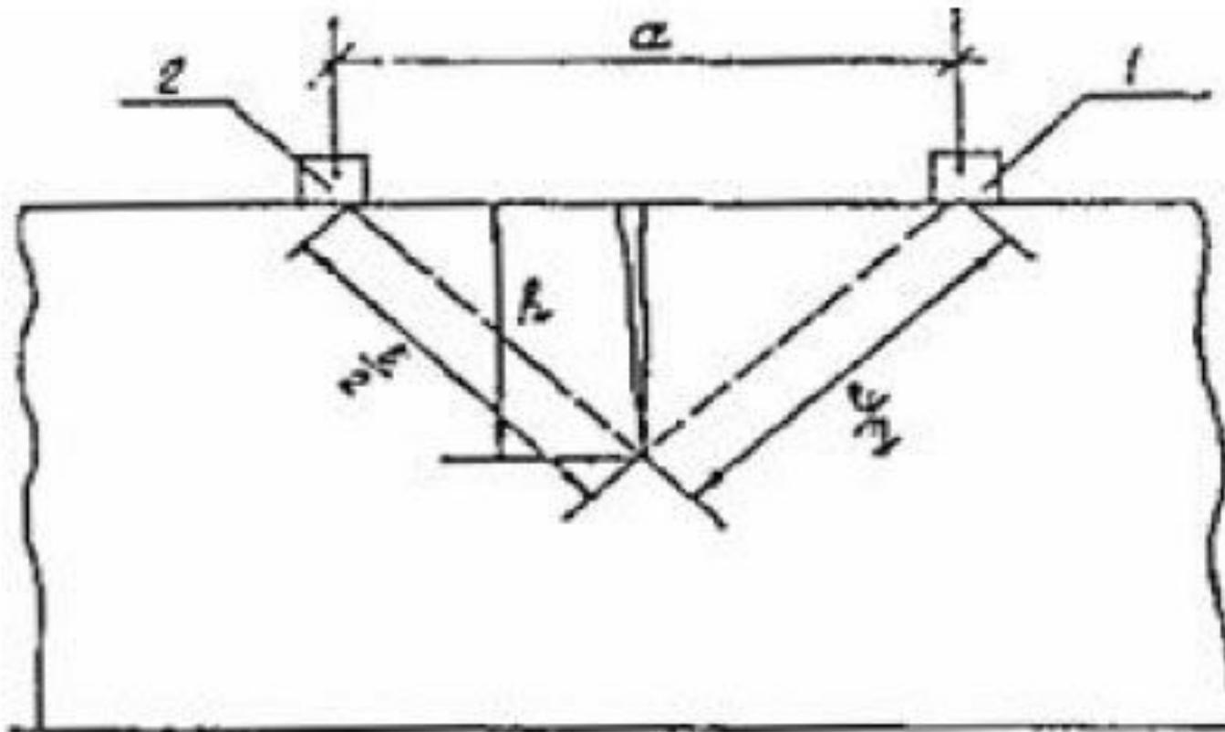
Определение глубины трещин в конструкции 1 - излучатель;
