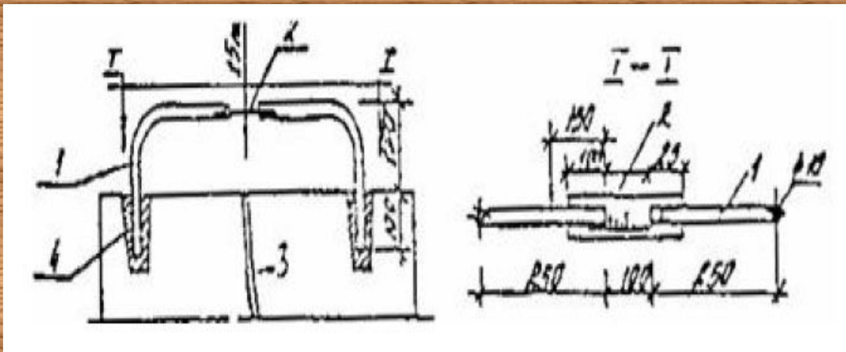
Щелемер конструкции ЛенГИДЕПА 1 - скоба; 2 - измерительная шкала;
