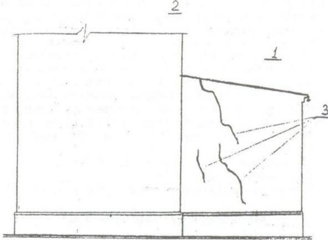
Деформация каменной стены (кладка из кирпича) существующего здания от воздействия на его фундамент нагрузки нового здания:
