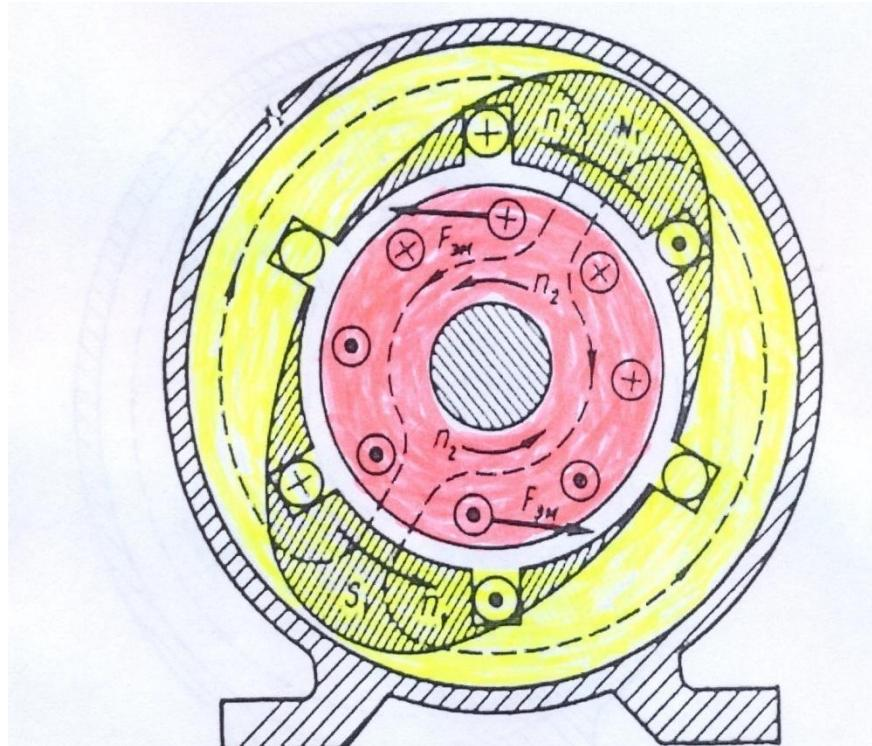
Рис. 6.4. К принципу действия асинхронного двигателя
