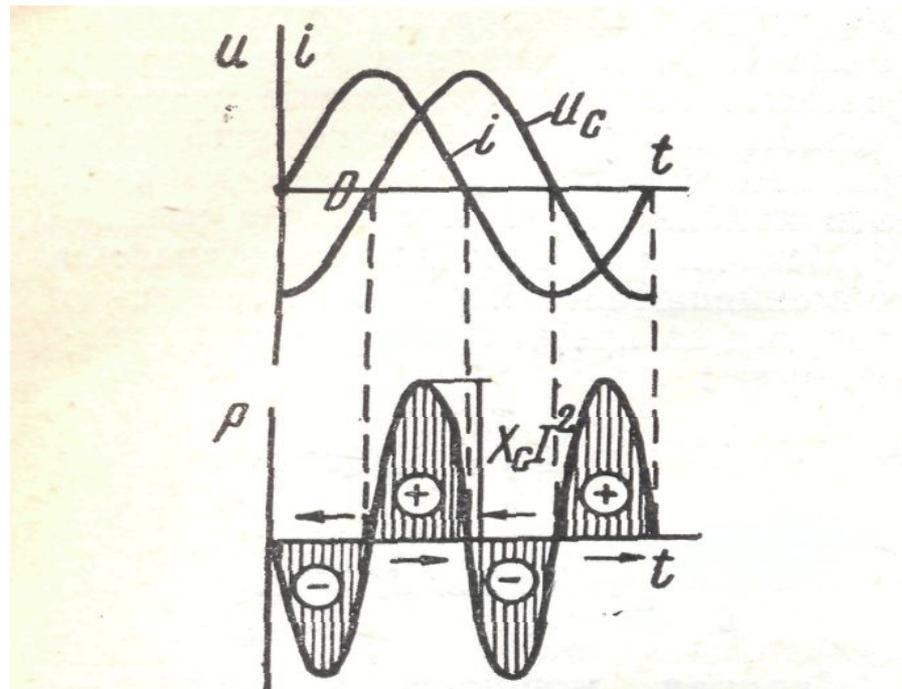
Рис. 8-5. График мгновенной мощности в цепи с емкостью.
