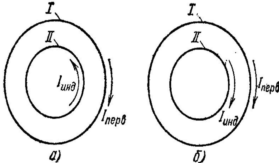
Рис 261. Связь между направлением первичного тока  $I_{перв}$ , создающего магнитное поле, и направлением индукционного тока  $I_{инд}$ :
