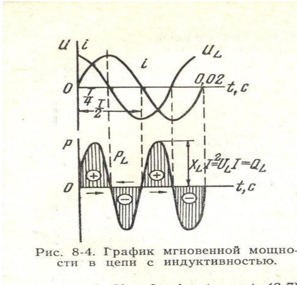
Рис. 8-4. График мгновенной мощности в цепи с индуктивностью.
