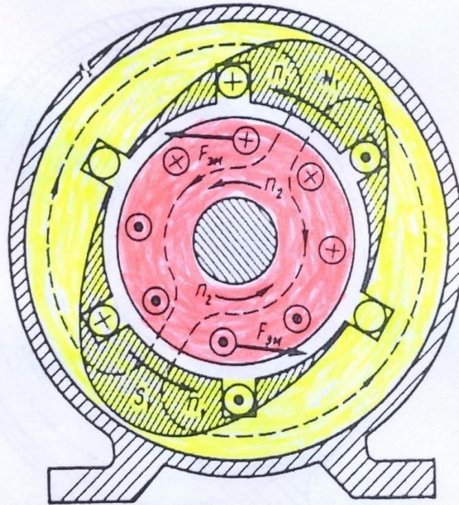
Рис. 6.4. К принципу действия асинхронного двигателя
