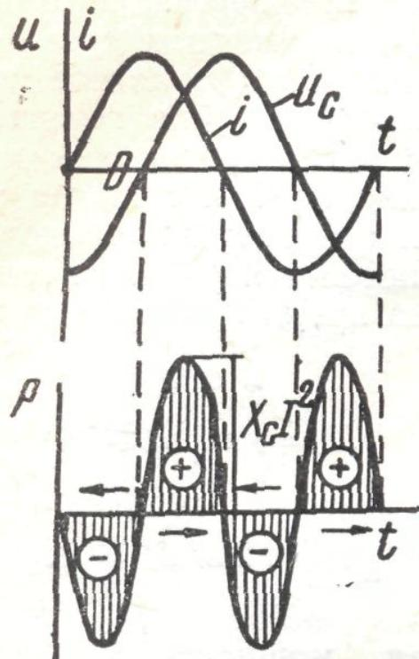
Рис. 8-5. График мгновенной мощности в цепи с емкостью.
