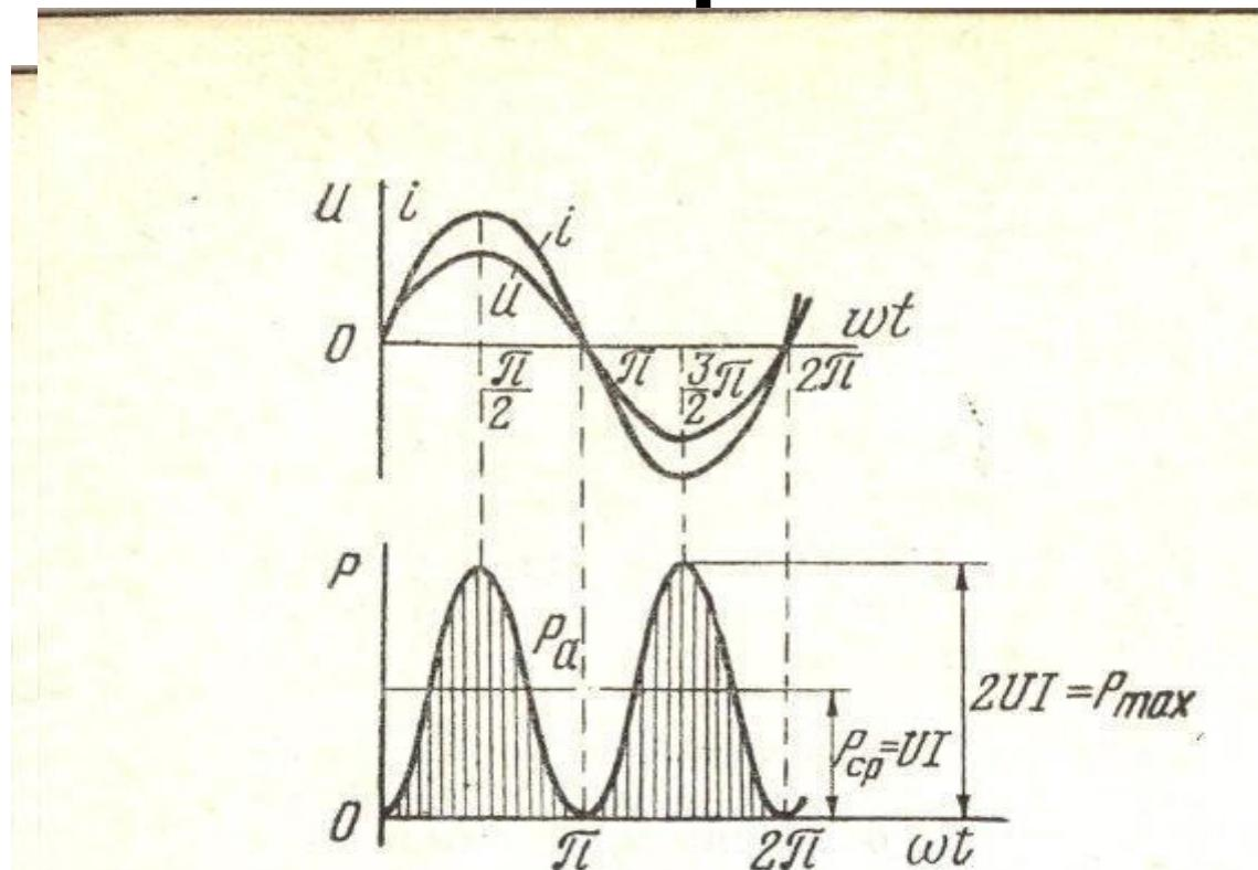
Рис. 8-3. График мгновенной мощности в цепи с активным сопротивлением.
