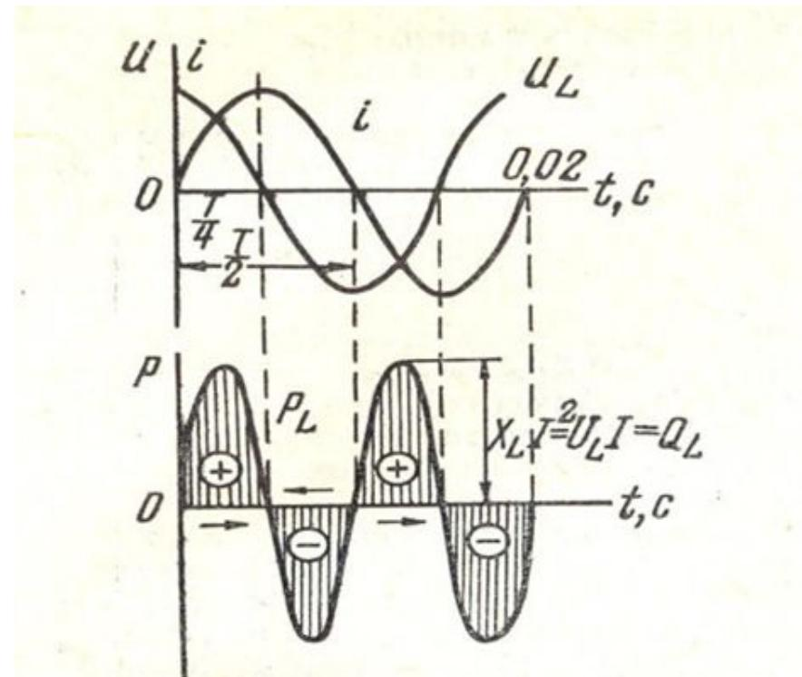
Рис. 8-4. График мгновенной мощности в цепи с индуктивностью.
