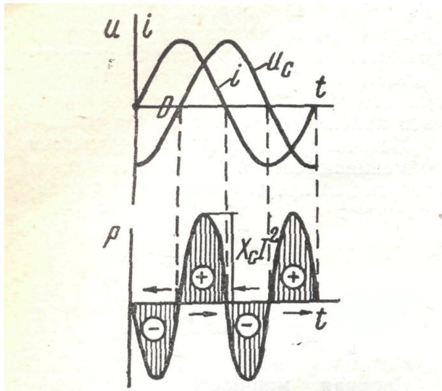
Рис. 8-5. График мгновенной мощности в цепи с емкостью.
