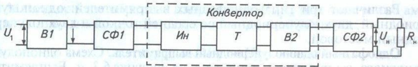
Рис. 6.2. Структурная схема вторичного источника постоянного напряжения с преобразователем частоты: B1 — выпрямитель сетевого напряжения U_1 ; C\Phi1 — сглаживающий фильтр выпрямителя B1 ; Ин — инвертор; T — трансформатор; B2 — выпрямитель напряжения повышенной частоты; C\Phi2 — сглаживающий фильтр выпрямителя B2
