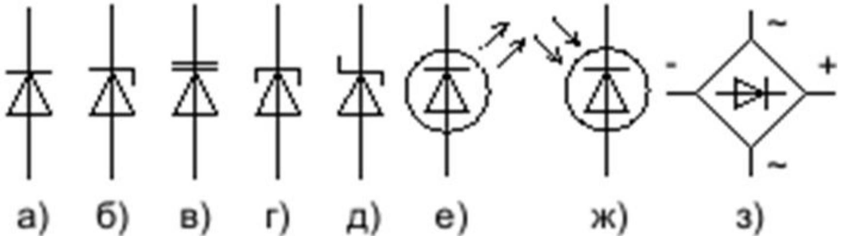
а) Так обозначают выпрямительные, высокочастотные, СВЧ, импульсные и диоды Гана; б) стабилитроны; в) варикапы; г) тоннельные диоды; д) диоды Шоттки; е) светодиоды; ж) фотодиоды; з) выпрямительные блоки
