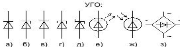
а) Так обозначают выпрямительные, высокочастотные, СВЧ, импульсные и диоды Гана; б) стабилитроны; в) варикапы; г) туннельные диоды; д) диоды Шоттки; е) светодиоды; ж) фотодиоды; з) выпрямительные блоки
