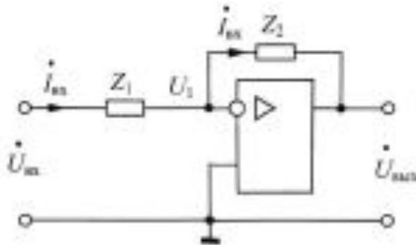
Рис. 4. Базовая схема для построения инвертирующего усилителя,
