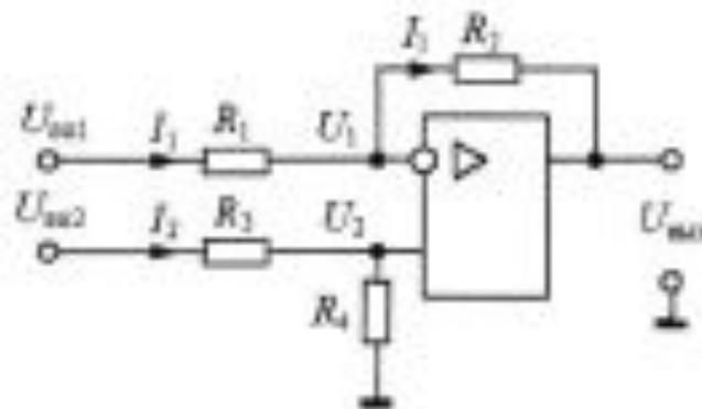
Вычитатель (рис. 9). Составим систему уравнения для схемы на рис. 9
