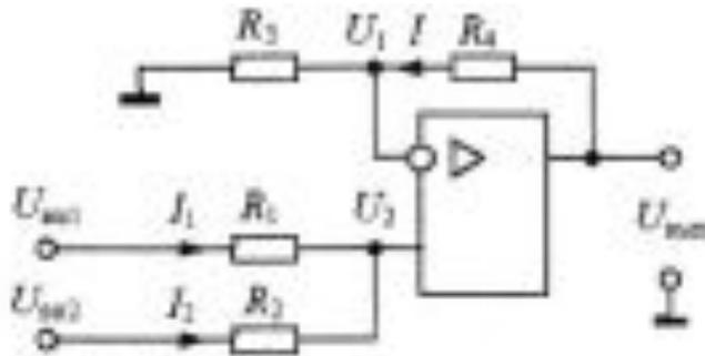
Неинвертирующий сумматор (рис. 8). Составим систему уравнения для схемы на рис. 8 с учетом того, что  $I_1 + I_2 = 0$ :
