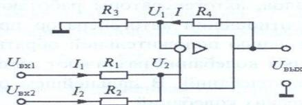
Рис. 8. Неинвертирующий сумматор
