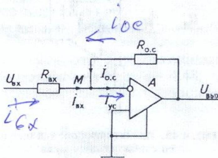
Рис. 4.44. Инвертирующий усилитель на ОУ
