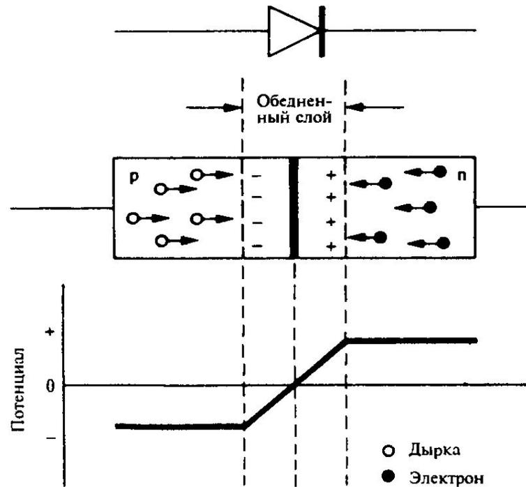
Рис. 1.9. Условное обозначение полупроводникового диода,  $p$ - $n$  переход с обедненным слоем и изменение потенциала.
