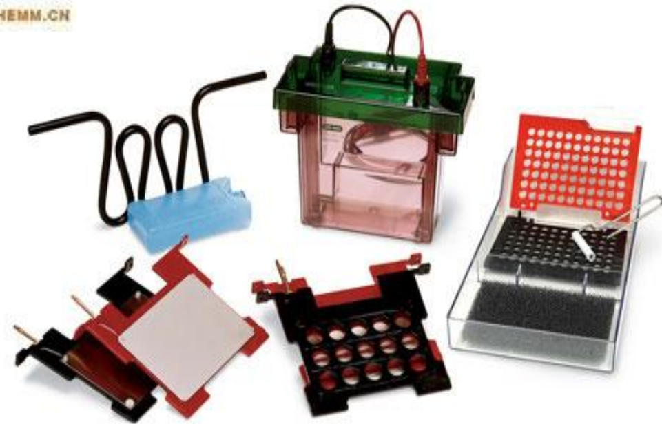
Камера для переноса белков с геля на нитроцеллюлозную мембрану
