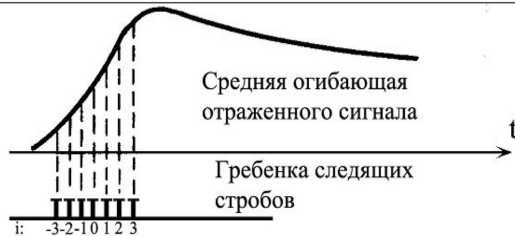
Расположение следящих стробов относительно усредненной огибающей отраженного сигнала
