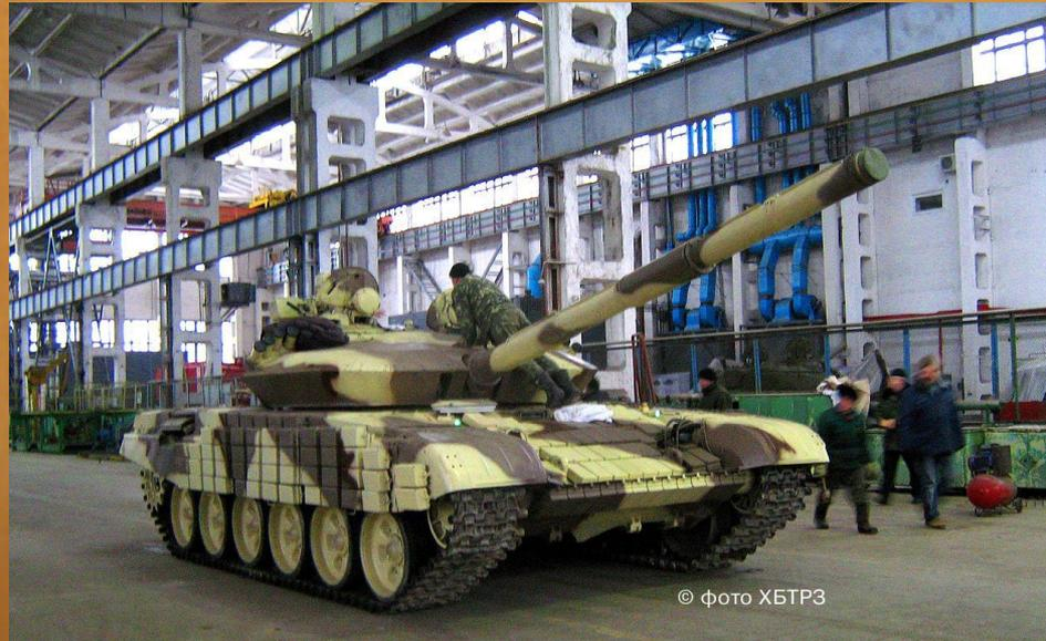
*Агрегатный метод ремонта* заключается в том, что снятые с объекта неисправные агрегаты и узлы заменяются новыми или заранее отремонтированным. Агрегатный метод ремонта по сравнению с индивидуальным имеет ряд преимуществ:
