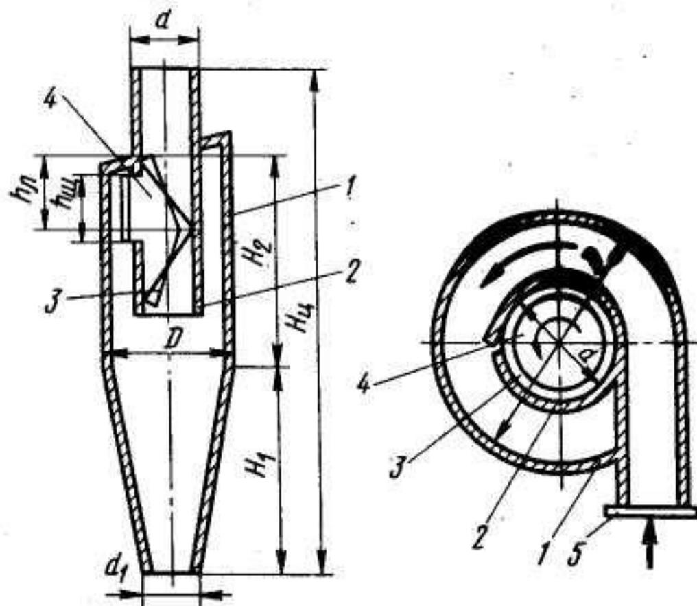
1 – корпус; 2 – выхлопная труба; 3 – направляющая лента; 4 – щель для подсоса воздуха с остаточной запыленностью; 5 – входной патрубок
