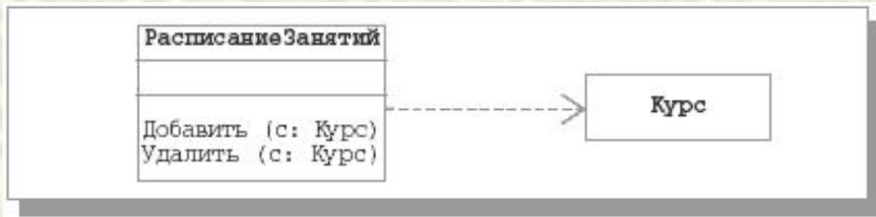
*Зависимость* показывается прерывистой линией со стрелкой, направленной к *классу*, от которого имеется зависимость.
