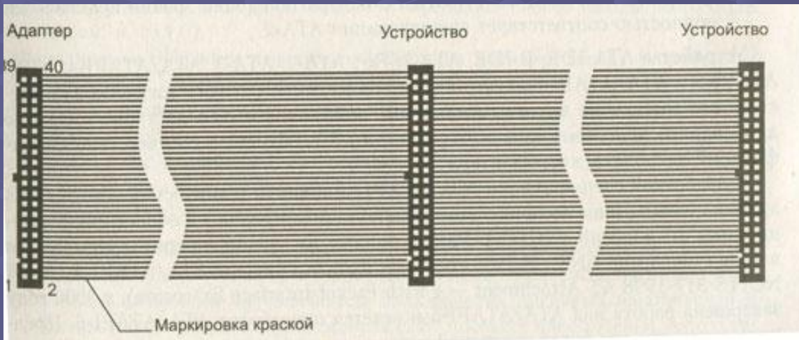
Сигнальный разъем IDE/EIDE и разъем питания
