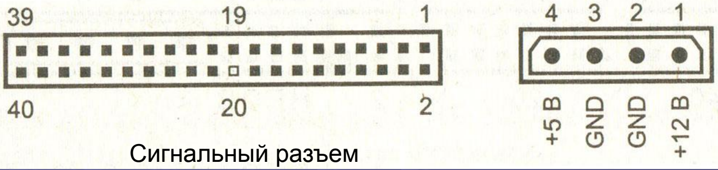
Сигнальный разъем IDE/EIDE и разъем питания
