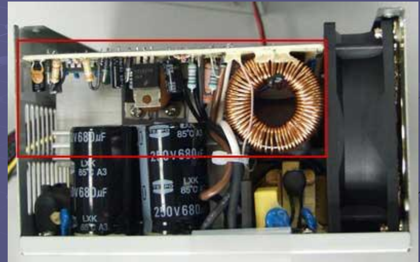
Плата активного PFC (Thermaltake PurePower HPC-420-302DF)
