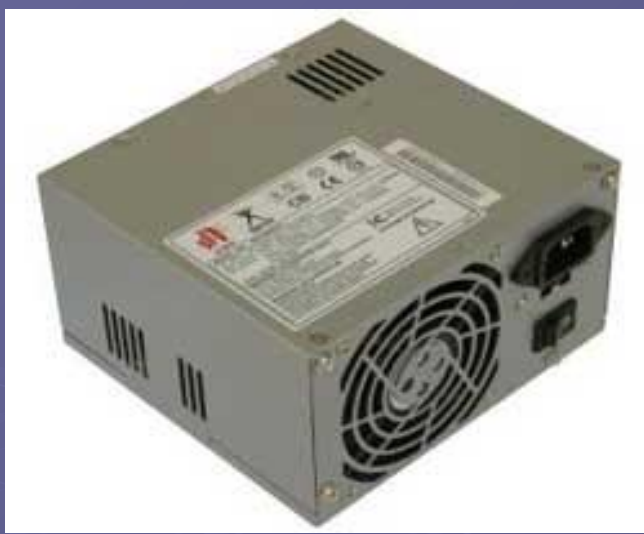
Блоки питания с 80x80 вентиляторами (тип 1 и тип 2)
