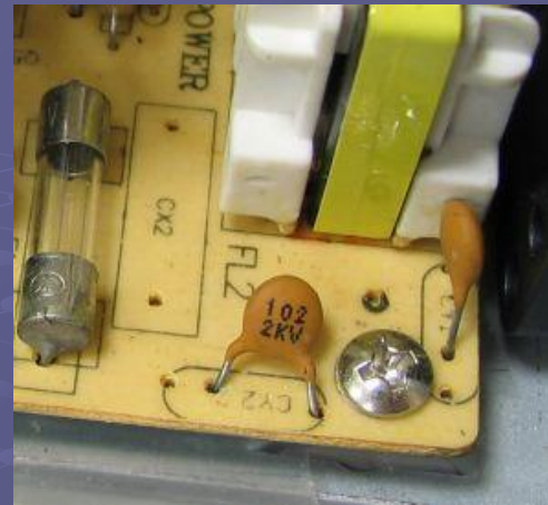
X-конденсаторы на складе кончились, Y-конденсаторы еще были, хотя кто-то по ним ногами уже успел походить
