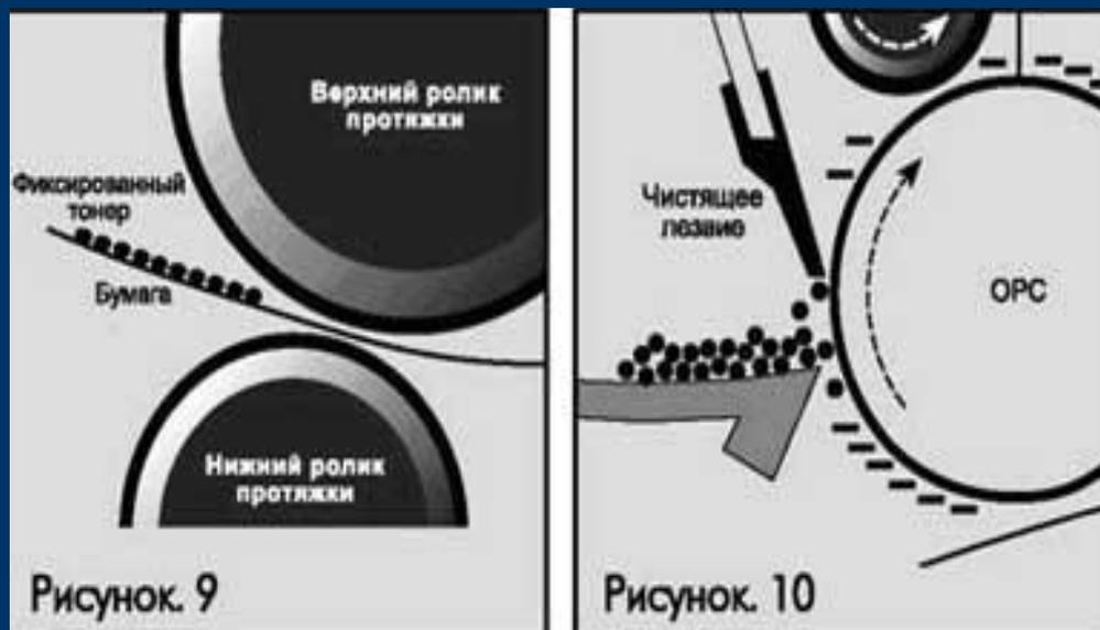
“Стирание” изображения. На этом этапе с поверхности барабана “стирается” скрытое изображение, нанесенное лазерным лучом. При помощи вала первичного заряда поверхность фотобарабана равномерно “покрывается” отрицательным зарядом, который восстанавливается в тех местах, где он был частично снят под действием света.
