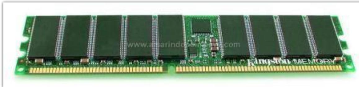
Физически память **DRAM** состоит из **ячеек**, созданных в полупроводниковом материале, в каждой из которых можно хранить определённый объём данных, **от 1 до 4 бит**. Совокупность ячеек такой памяти образуют условный «прямоугольник», состоящий из определённого количества **строк и столбцов**. Один такой «прямоугольник» называется **страницей**, а совокупность страниц называется **банком**. Весь набор ячеек условно делится на несколько областей.
