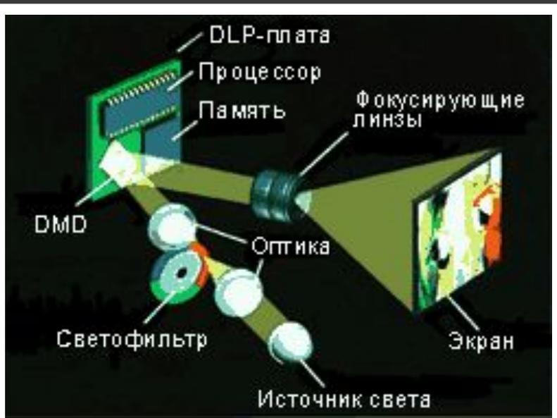
В одноматричном DLP-проекторе световой поток лампы пропускается через вращающийся фильтр с тремя секторами, окрашенными в цвета составляющих пространства RGB (в современных моделях к трем цветным секторам добавлен четвертый - прозрачный, что позволяет увеличить световой поток мультимедийного проектора при демонстрации изображений с преобладающим светлым фоном).
