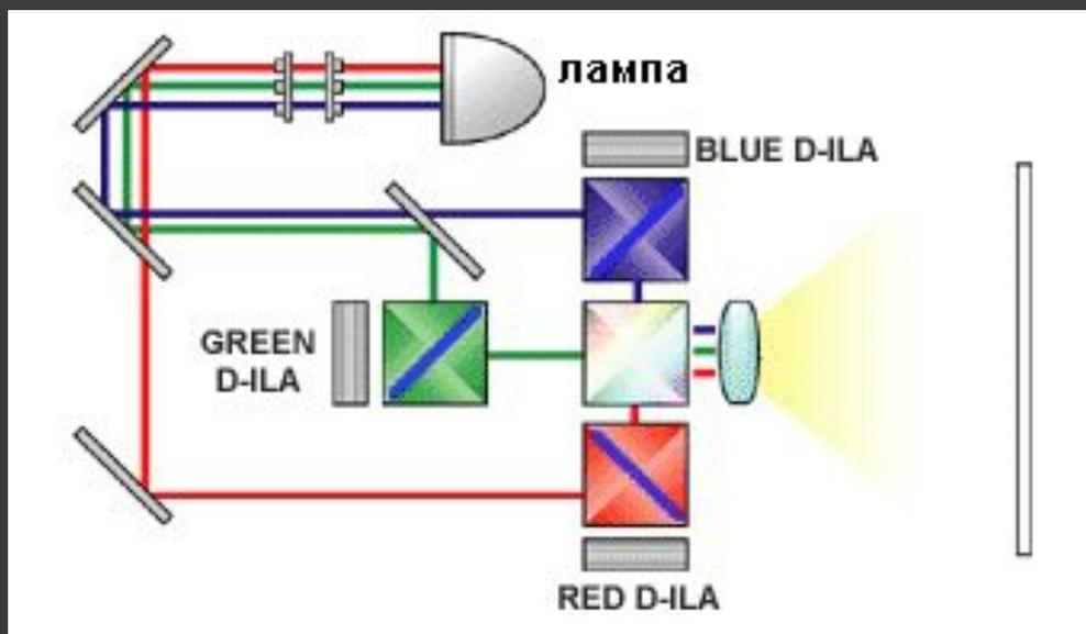
Для создания цветного проектора соответственно используется схема с тремя матрицами D-ILA и тремя PBS, последовательно переносится к выходным электродам.
