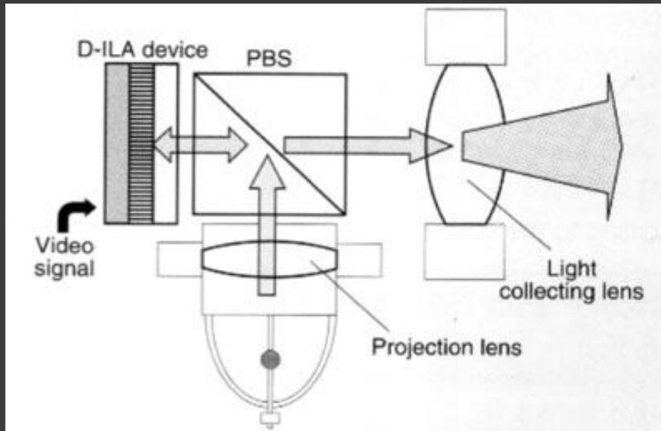
Свет от лампы-источника разделяется PBS на две компоненты - P (свет с волной, параллельной поверхности) и S (перпендикулярной волной). Компонента P проходит насквозь через PBS и не используется при формировании сигнала, а сразу идет на линзу. Компонента S подается на элемент D-ILA. Свет проходит сквозь жидкие кристаллы и отражается
