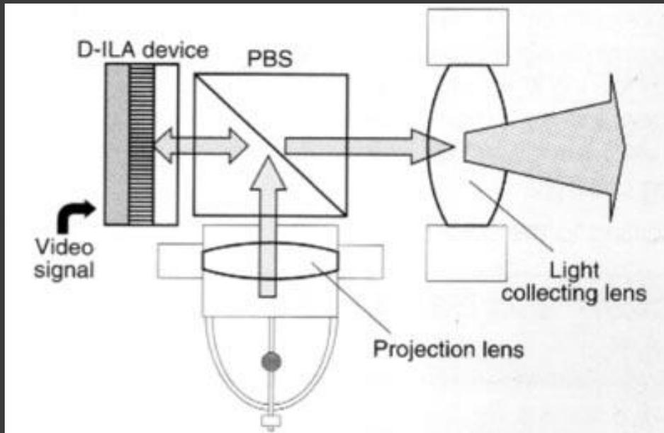
Если напряжение на электрод пикселя не подается, жидкие кристаллы сохраняют свое вертикальное положение. Свет не модулируется, сохраняя ориентацию волны S, а значит, отражается PBS полностью на лампу. Так достигается черный цвет. Если на электрод подается напряжение, жидкие кристаллы
