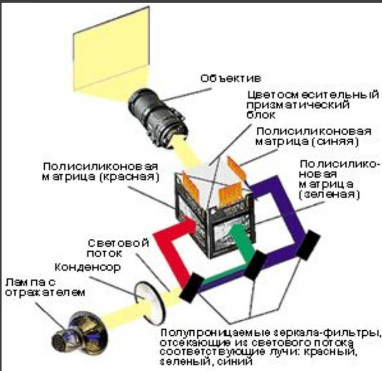
дихроичные зеркала-фильтры выделяют три цветовые составляющие (красную, синюю и зеленую) и направляют их на соответствующие LCD-матрицы. Сформированные ими цветные изображения объединяются в цветосмесительном призматическом блоке в одно полноцветное, которое затем через объектив проецируется на внешний экран.
