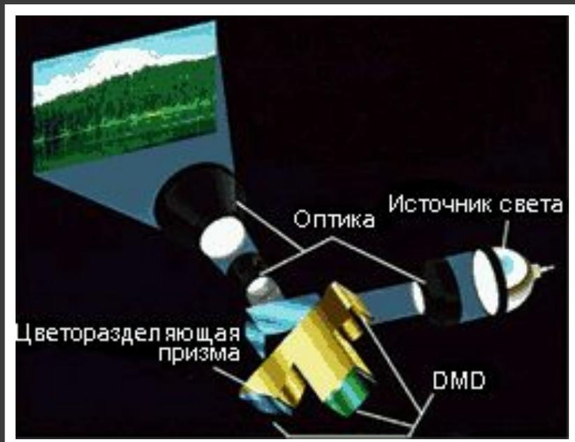
В трехматричных DLP-проекторах световой поток лампы с помощью дихроичных призм расщепляется на три составляющих (RGB), каждая из которых направляется на свою DMD-матрицу, формирующую картинку одного цвета. Объектив аппарата проецирует на экран одновременно три цветных картинки, формируя таким образом полноцветное изображение.
