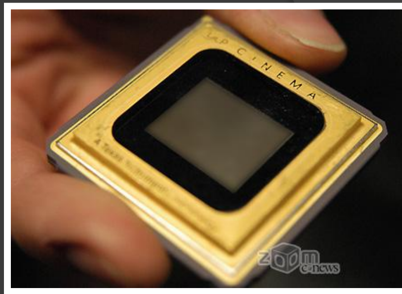
На этом DMD-чипе, основе DLP-технологии расположено 2 073 600 микрозеркалец
