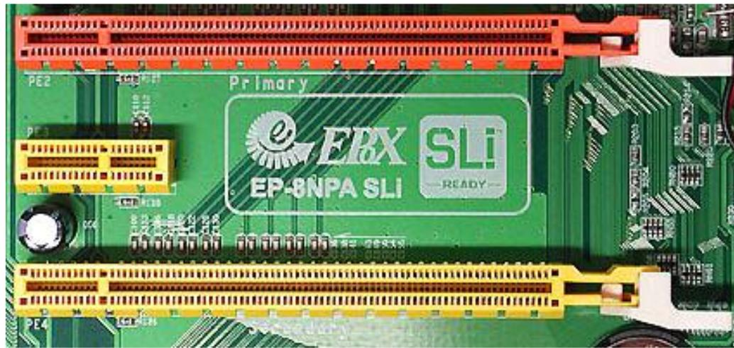
**PCI Express** или **PCI-E** — компьютерная шина, использующая программную модель шины **PCI** и высокопроизводительный физический протокол, основанный на последовательной передаче данных. Увеличенная пропускная способность — спецификация **PCI Express 2.0** определяет максимальную пропускную способность одного соединения как **5 Гбит/с**.
