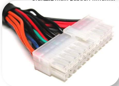
ATX с 24 контактами (Extended ATX)
