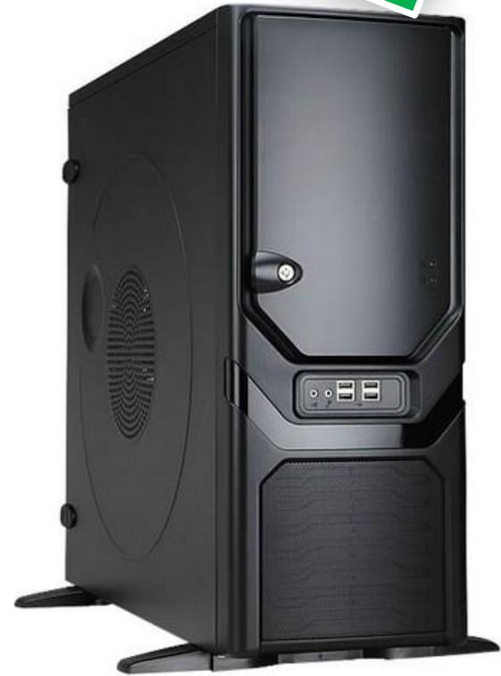
От этого параметра зависит множество важных факторов: защита железа от внешних электромагнитных волн, защита пользователя от излучения компьютера, прочность и устойчивость каркаса. Наиболее выгодный вариант - корпус из **листовой стали** толщиной от 0,7 мм. Существуют и алюминиевые кейсы, однако этот материал больше пригоден для создания дополнительных деталей и конструкций.
