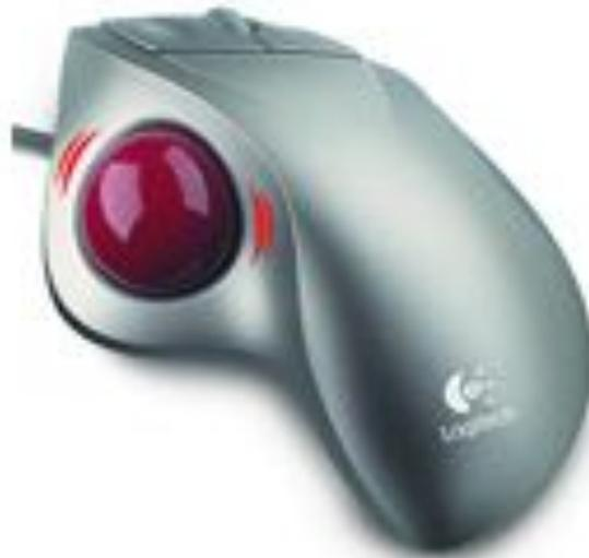
**Трекбол** (шаровой манипулятор, мышь «наизнанку») – вместо перемещения устройства по столу, в трекболе двигается шарик. Удобен в случаях, когда мало места. Широко используется в портативных компьютерах.
