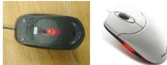
**Мышь** – это устройство-манипулятор для управления курсором и для работы с графическим интерфейсом.
