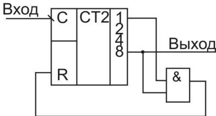
Делитель частоты на счётчике и элементе 2И
