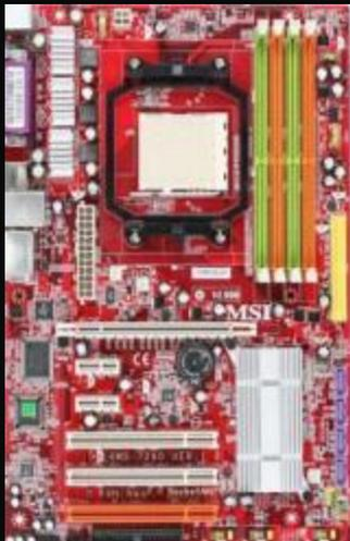
3. Чипсет (набор системной логики) - это набор микросхем, состоящий из северного и южного мостов.
